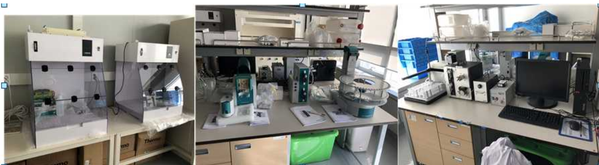
그림2. 해수 미 해양 환경 시료 중 미량금속 분석 위한 전처리 장비 (콜로이드 상 분리 위한 원심분리 장비 및 선상 등 현장 활용용 이동형 청정 실험 환경 벤치 (왼쪽), 유기 착화 형태 미량원소 농도 분석 용 전기전압법 장비 (Cyclic voltammetry) (가운데) 및, 현장(선상) 적용 가능 미량원소 분석 장비 (유동 주입 분석장비, Flow injection analysis) (오른쪽) 을 및 본 연구자의 연구실에 도입하여 현재 기초 장비운영 개시 및 실험 방법 구축 중
