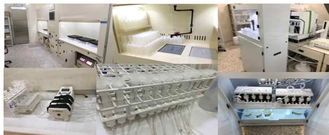
그림 5 연구청사 1연구동에 구축된 청정 실험 환경과 용존 미량원소 실험 관련 세척 및 전처리 장비(왼쪽)와 본 청정실험실에 구축된 해수 중 용존 미량원소 전처리-질량분석기 (seaFAST)의 운용 사진 (오른쪽)
