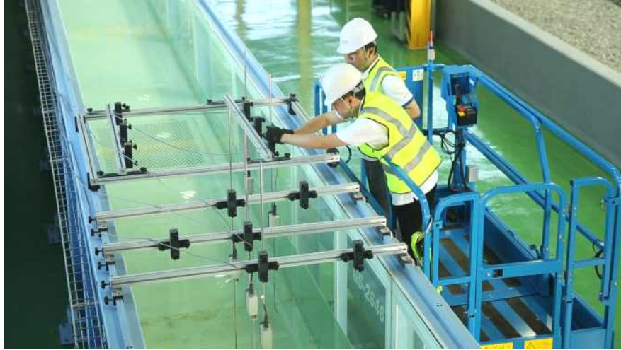
그림 3. 파고계 설치장면 (수리실험동 2차원 조파수조)
