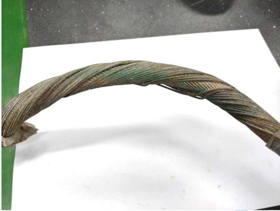
그림 11. 이사부호 DTW1 원치 케이블에 발생한 +킹크 증상 확대 사진
