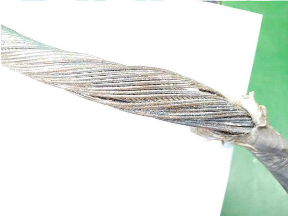
그림 12. 이사부호 DTW1 원치 케이블에 발생한 -킹크 증상 확대 사진
