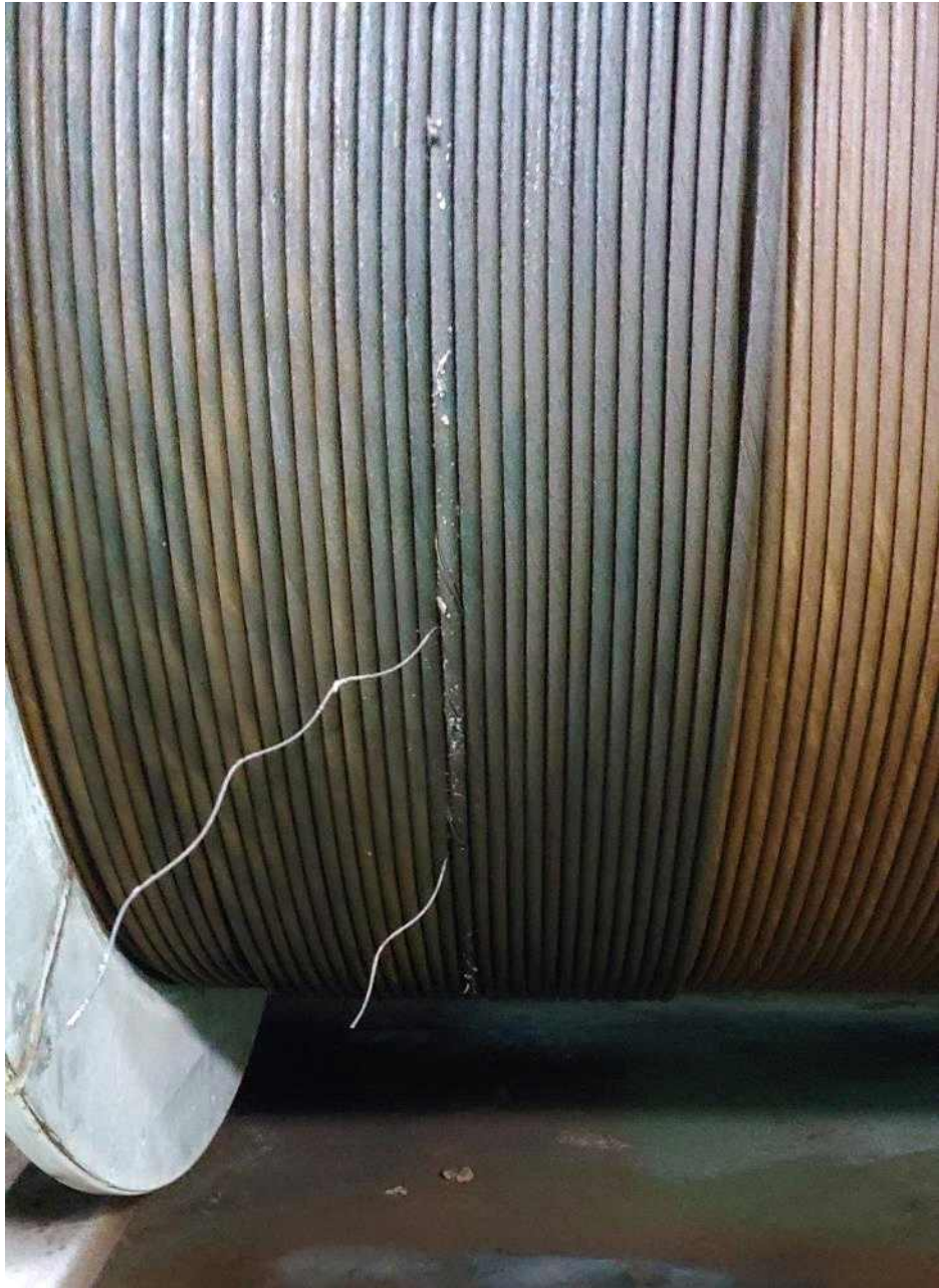
그림 14. 레벨 와인더 오작동으로 손상된 이사부호 CTD 원치 케이블
