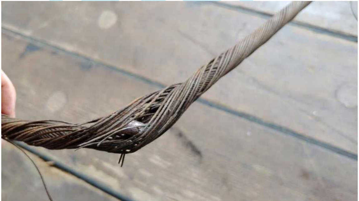
그림 5. 이사부호 CTD 원치 케이블 내부 와이어 부식으로 인한 절단 증상
