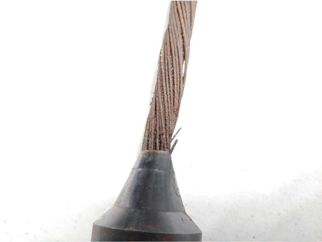
그림 4. 이사부호 CTD 원치 케이블 터미네이션 부분에 발생한 외부 와이어 절단 증상
