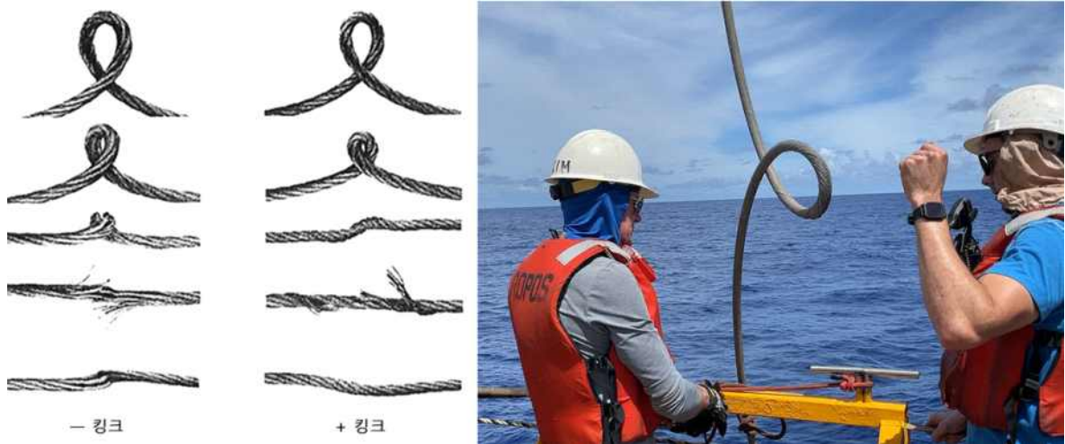
그림 8. 윈치 케이블 킱크의 예시(좌측, 참조 자료: 서교알엔피, 와이어로프 사용시 주의사항) 및 2023년 4월 이사부호에서 ROV 운영 시 발생한 윈치 케이블 킱크 실제 장면 (우측)
