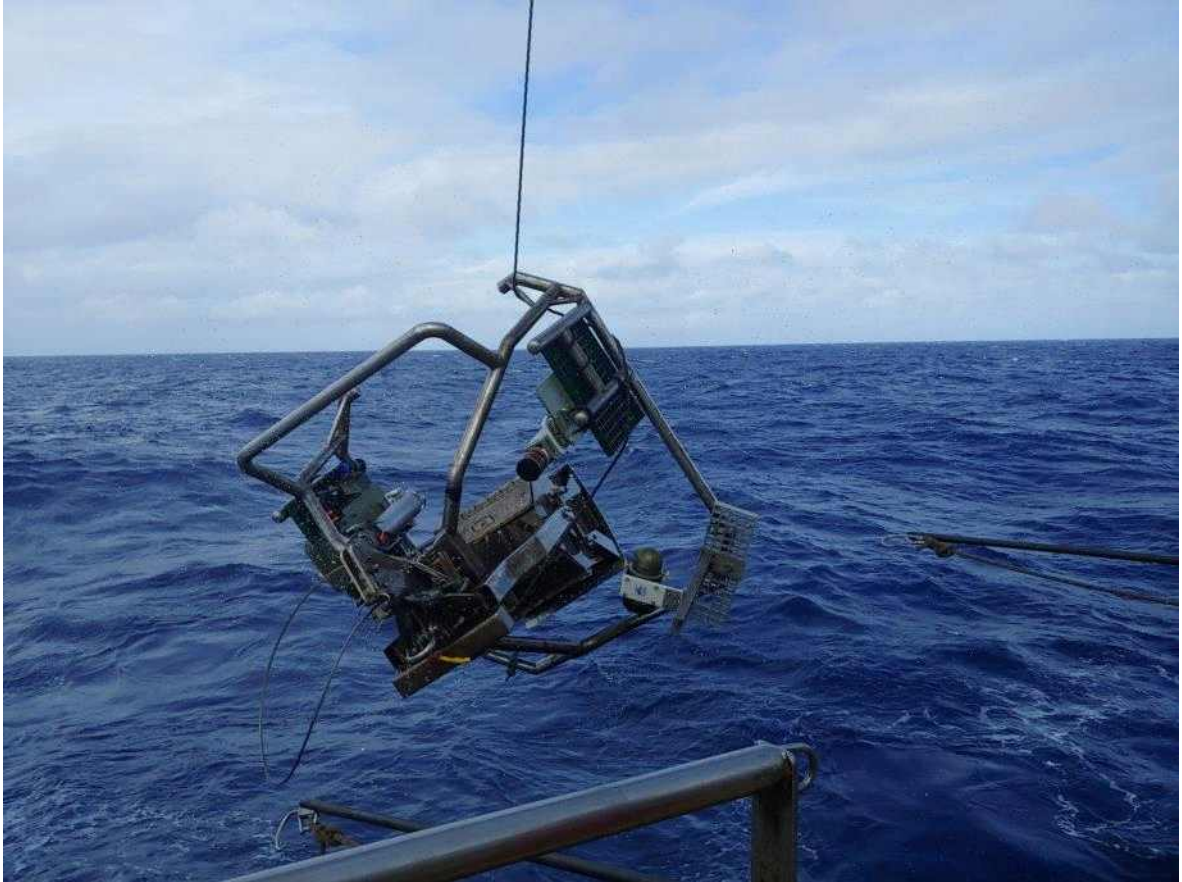
그림 16. 윈치 케이블이 박스코어를 휘감아 회수된 장면
