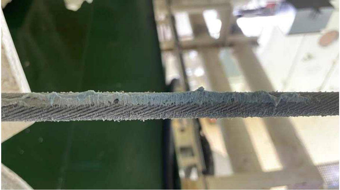
그림 2. 이사부호 CTD 원치 케이블 신품에 도포된 부식 손상 방지용 그리스(윤활유)
