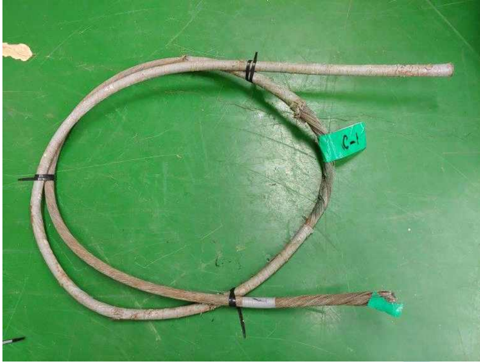
그림 9. 킹크가 발생한 이사부호 DTW1 원치 케이블 샘플
