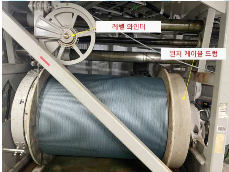
그림 13. 이사부호 CTD 원치 시스템의 케이블 드럼과 레벨 와인더
