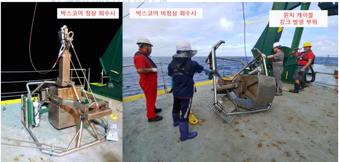
그림 17. 박스코어 정상 회수 및 비정상 회수 (윈치 케이블 킥 발생) 비교
