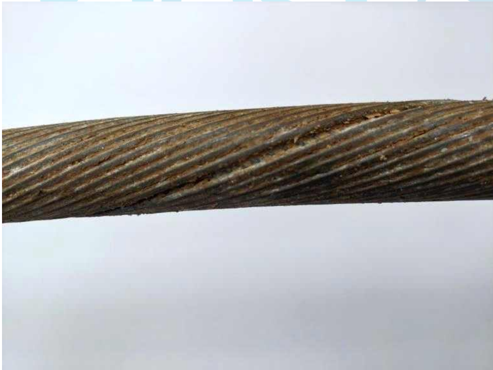
그림 10. 이사부호 DTW1 원치 케이블 킹크 경증상(벌어짐 증상) 확대 사진
