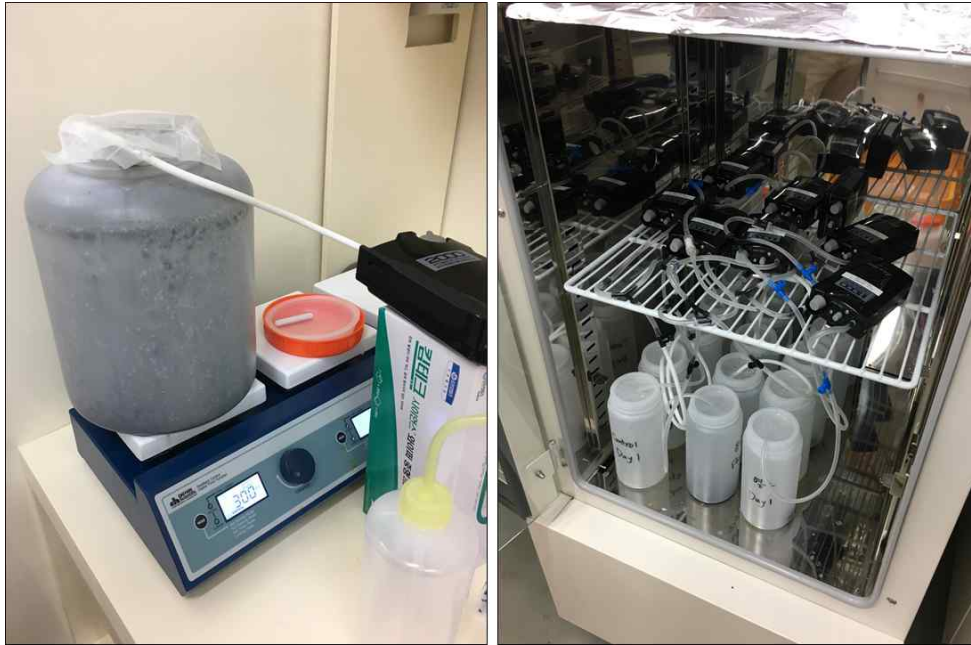
그림 3.2. 선광 전 열수광상 입자 용출수 제조 (좌) 및 동물플랑크톤 독성 실험 (우)
