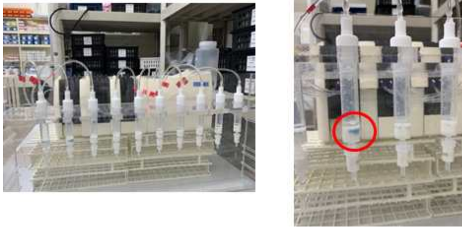
그림 4.24. Nobias resin을 이용한 용출수 내 금속 농축(붉은색 원)
