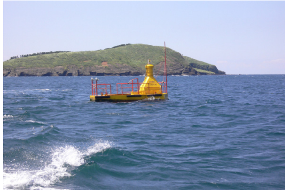
〈등부표용 BBDB형 부유식 파력발전장치 실해역 설치〉
