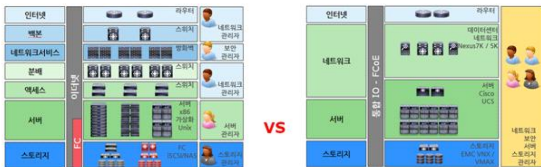
그림 61. 전통적인 데이터 센터 구조와 시스코의 패브릭 기반의 데이터 센터 아키텍처
