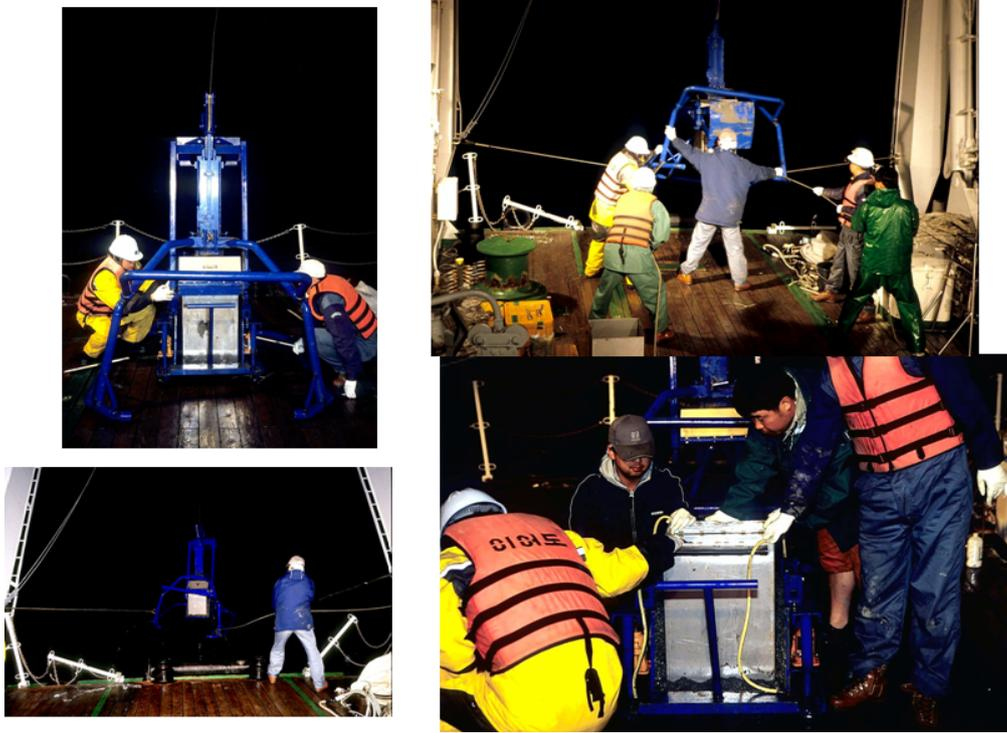
그림 2-4-4. 박스코어를 이용한 해저퇴적물 채취
