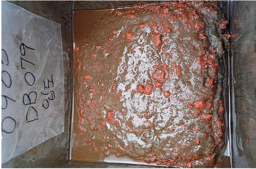
그림 2-8-21. DB-079 구획 표층퇴적물 사진(보크사이트 잔재물로 덮혀있음)
