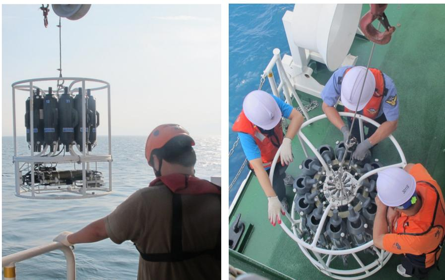
그림 2-6-4. 동해정해역을 조사한 해양경찰교육함의 CTD가 장착된 Rosette sampler.
