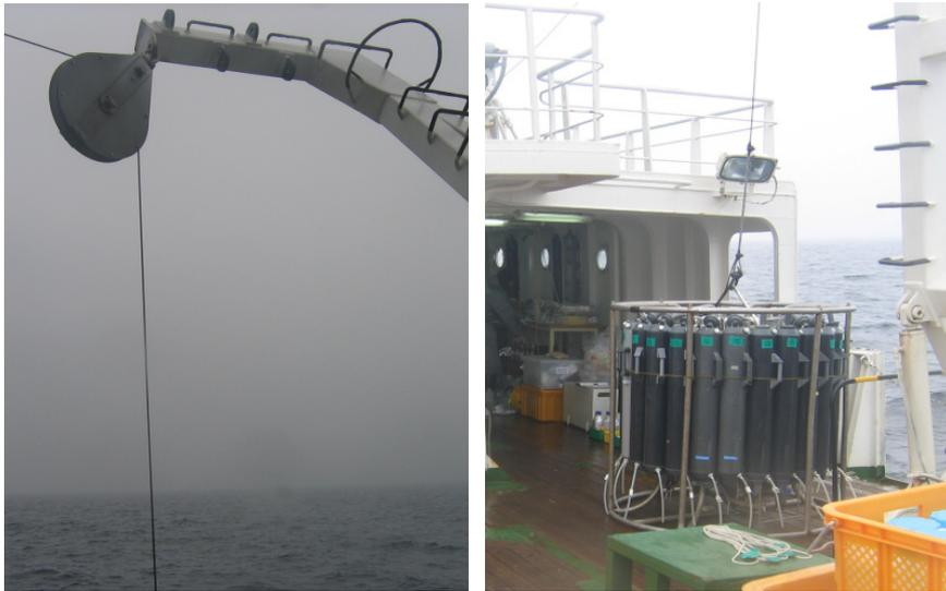
그림 2-6-3. 서해병해역을 조사한 한국해양과학기술원(KIOST) 조사선 이어도호의 CTD가 장착된 Rosette sampler.
