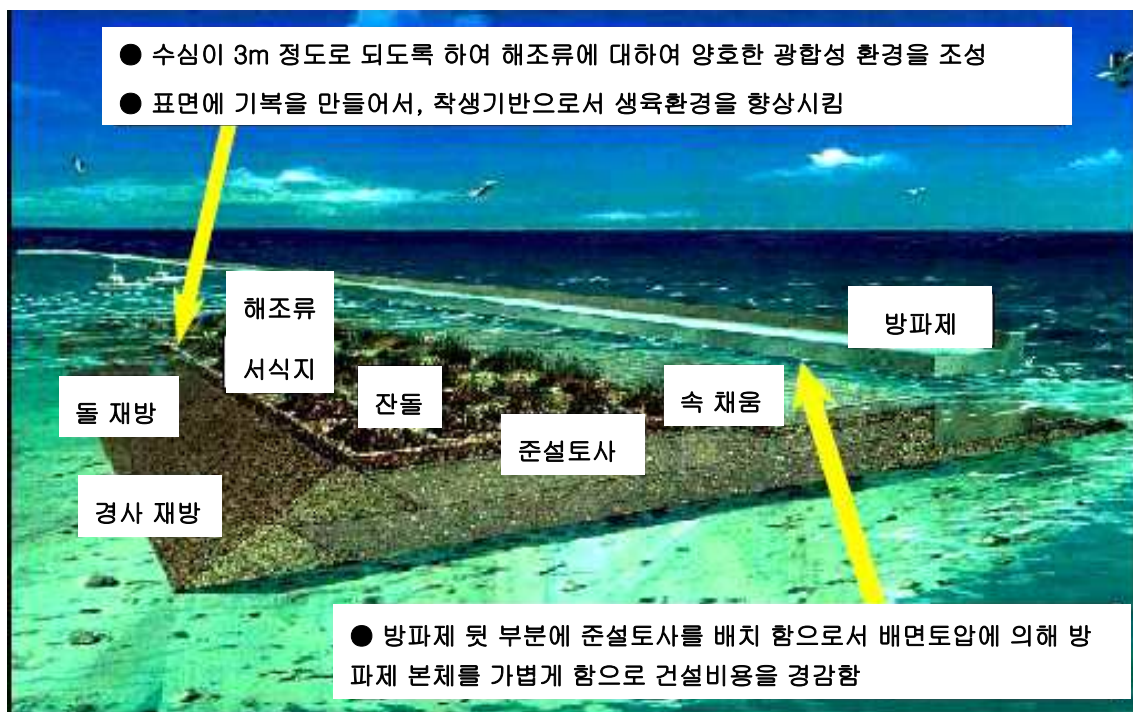
그림 2-4-8 일본의 해양오염퇴적물 재활용 사례(방파제 조성) 57)
