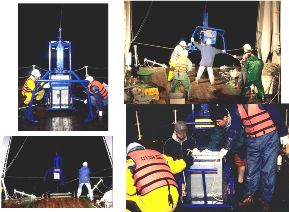
그림 2-4-4 박스코어러를 이용한 해저퇴적물 채취
