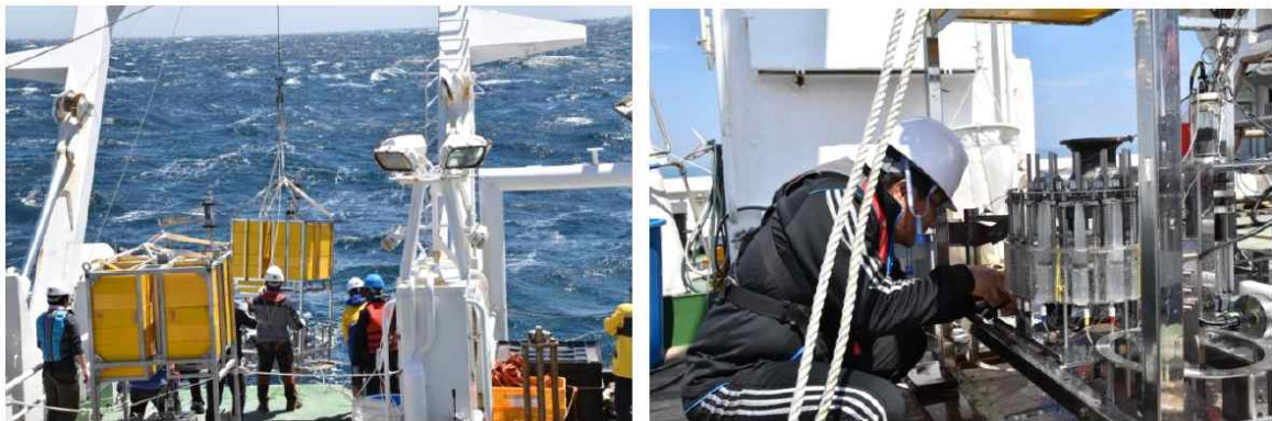
[그림 5-3] 벤틱랜서를 이용한 현장 배양 시료 채집 장면
