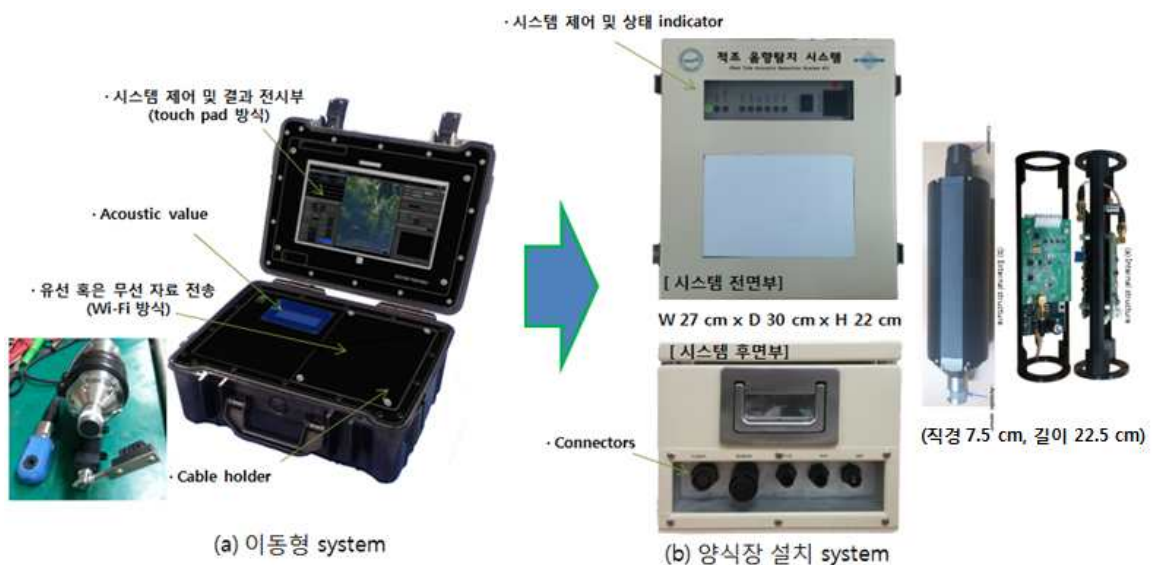
[그림 3-20] 이동형 및 양식장 설치형 적조 음향 탐지 시스템 (KIOST, 2014, 2015)
