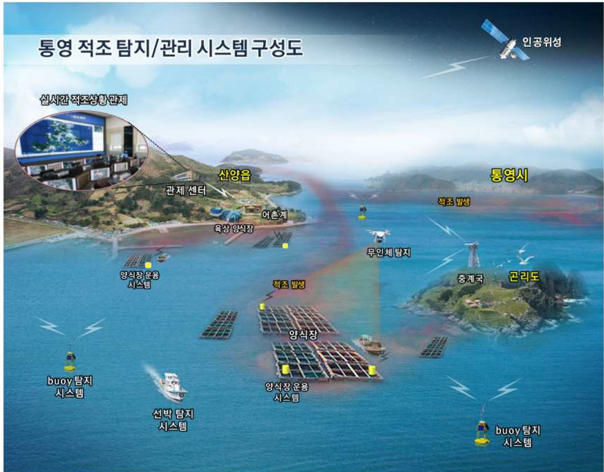
[그림 4-1] 통영 해역 적조 실시간 탐지·대응을 위한 통합관리 체계 구성도
