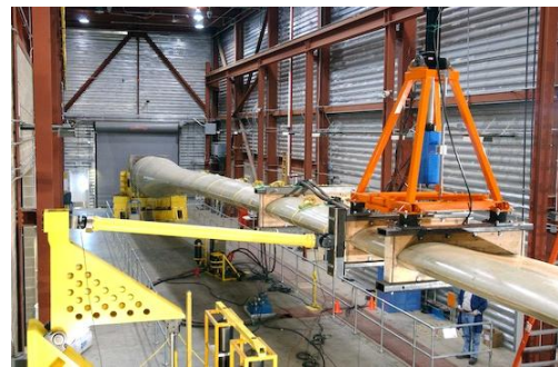
<그림 2.2.30> 블레이드 피로시험 장면
