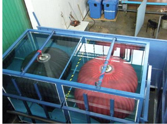
〈그림 2.3.13〉 유연막 방식 압축공기 수중저장 실험 시스템
