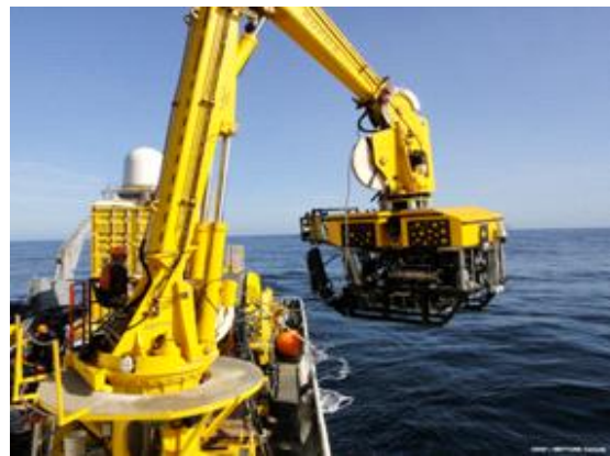
〈그림 2.3.11〉 수중장비 실패역 진회수 장치
