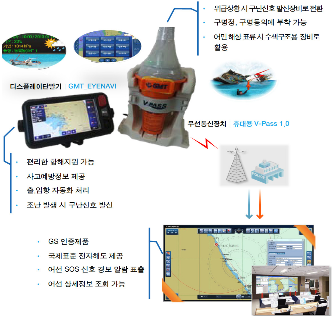
[그림 2-10] V-Pass 어선 종합관제 시스템 개념도
