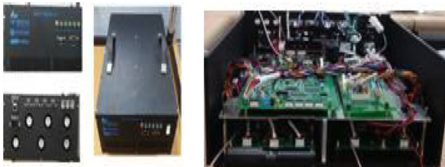
[그림 2-9] 구현된 해상 디지털 모뎀의 외형 및 플랫폼 보드가 실장된 모습
