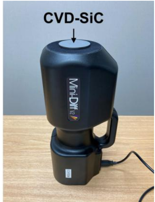
그림 3-1-14. CVD 코팅 전(좌)과 후(우)의 SiC 시편에 대한 BRDF 측정 세팅
