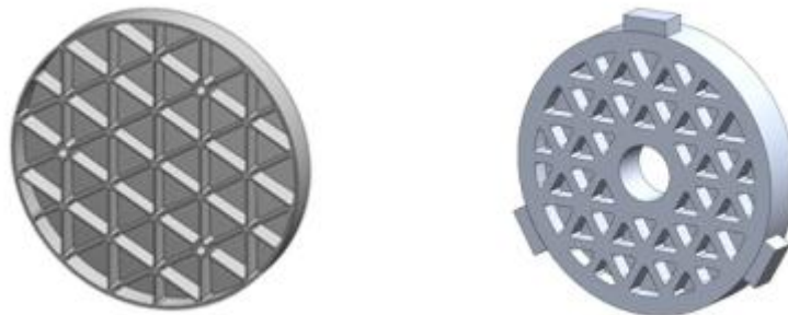
그림 2-6. 구경 300mm 비축-비구면 SiC 미러(좌) 및 구경 300mm 광축-비구면 Al6061 미러(우) 구조 설계
