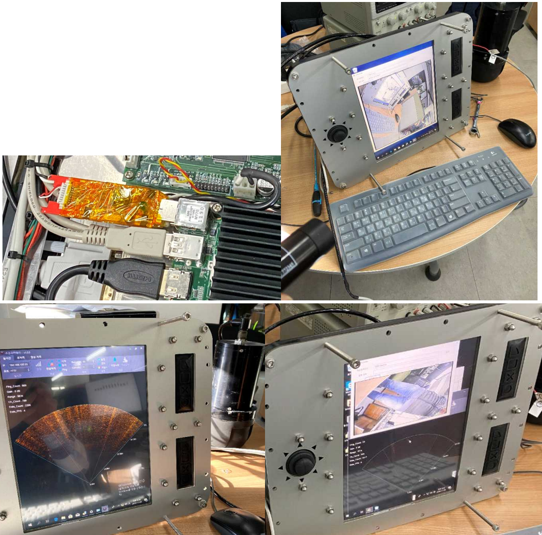
그림 3.58 휴대용 다이버 영상 장비의 수중전시기에 이미지소나 영상과 광학영상 전시 화면
