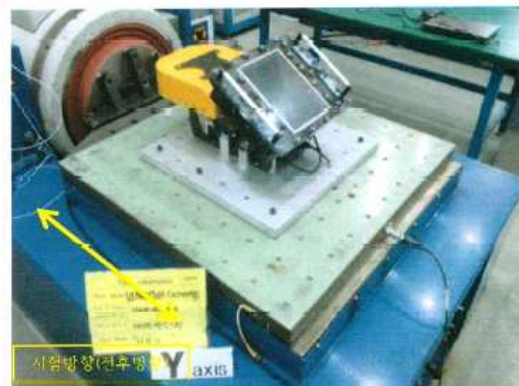
사진 1-2 Y 축 설치
