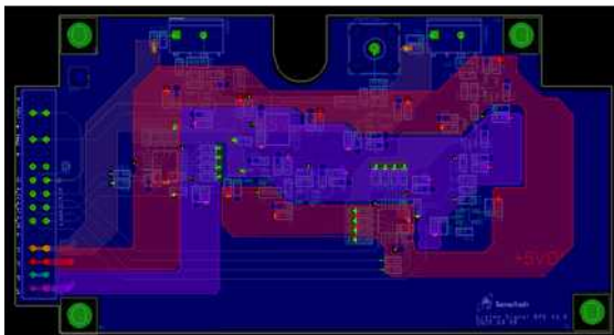
그림 3.82 S/N 비 개선을 위한 8층 PCB 기법을 적용한 Signal board Artwork 설계 및 제작
