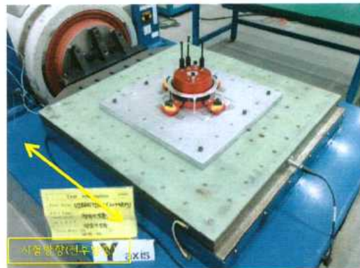
사진 1-2 Y 축 설치
