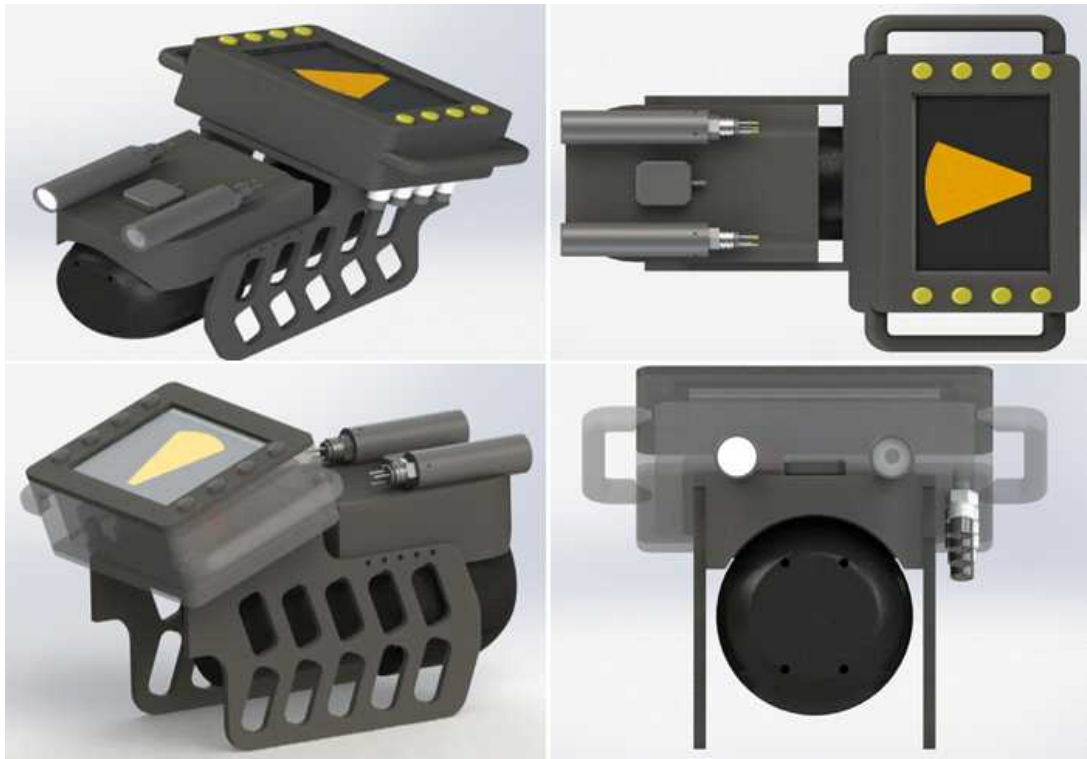
그림 3.35 음향소나 및 수중광학장비 2차 3D 모델링 형상도
