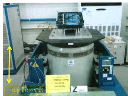
사진 1-3 Z 축 설치
