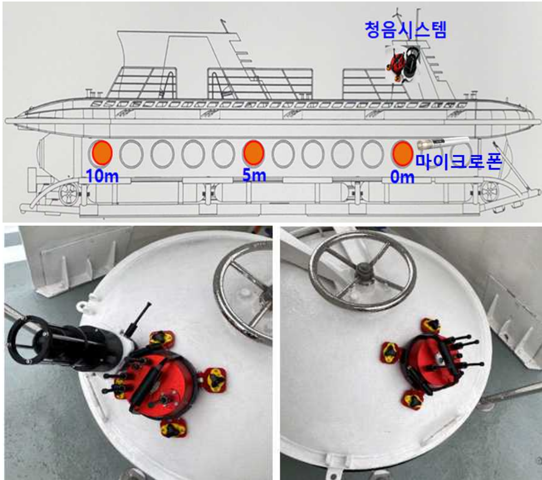
그림 3.62 서귀포 잠수함 1차 실험 시 구조신호 송출 위치 및 청음장치 부착 예시
