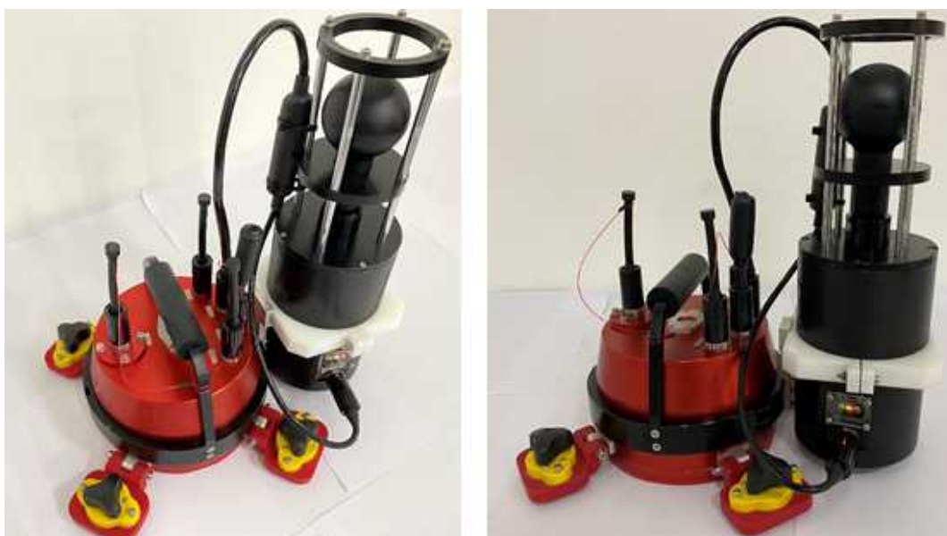
그림 3.88 선체 부착형 청음장치와 수중 무선 UT-AM 통신 모듈 최종 결과
