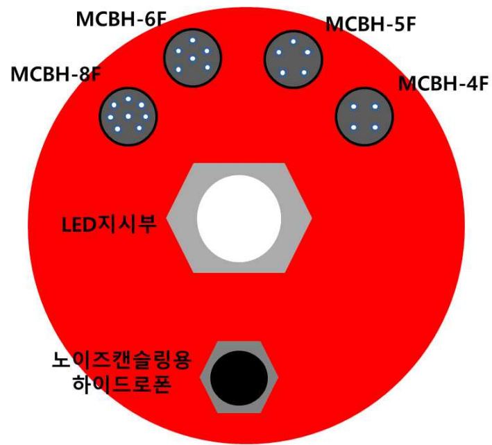
그림 3.18 2차년도 청음시스템 상단부의 커넥터 항목
