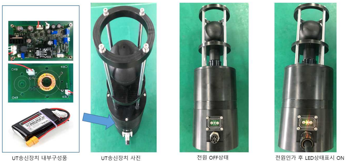
그림 3.39 청음 신호 송신을 위한 수중 무선 UT-AM 통신 모듈
