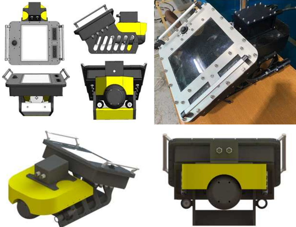
그림 3.119 휴대용 다이버 영상 장비의 부력재 재설계 3D 형상
