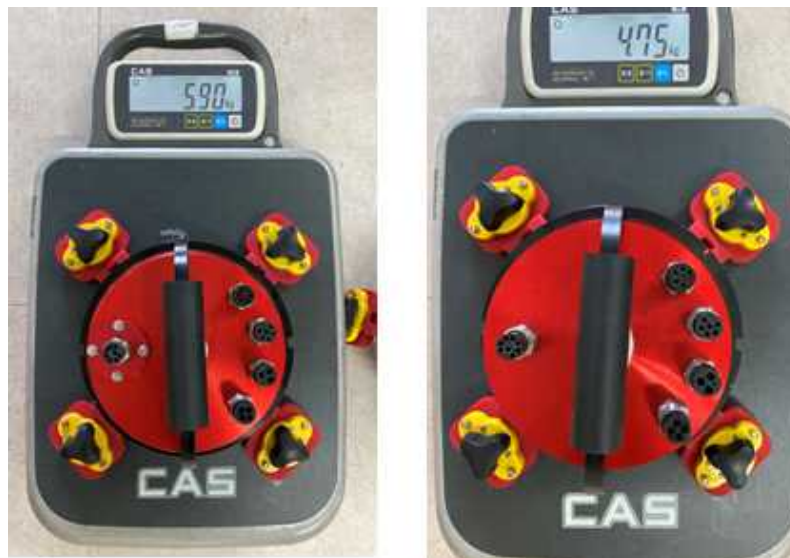
그림 3.87 청음시스템 본체부의 개선 (상) 전후 실물 및 (하) 무게 비교
