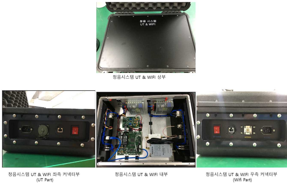
그림 3.40 해상 구조함용 UT-AM 수중통신 및 WIFI 통신을 위한 Deck Unit
