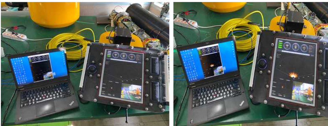
그림 3.124 휴대용 다이버 영상 장비의 전시 화면을 50m LAN 케이블을 통한 PC 전송 실험
