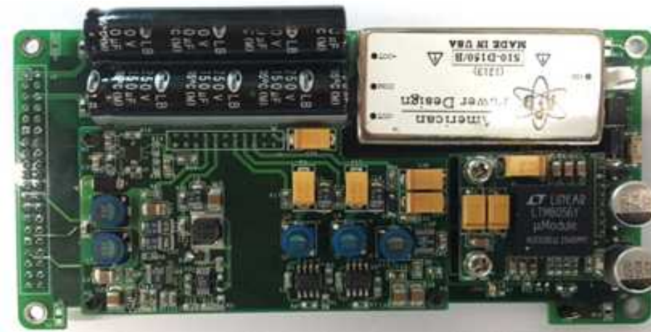
그림 3.51 신호처리 모듈 보드(FPGA)와 음향소나 모듈 보드
