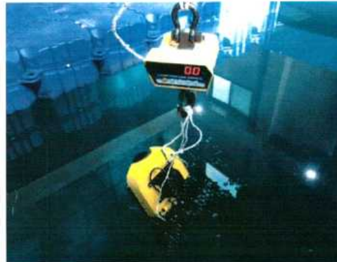
사진 4-3 무게 측정 (수중 투입 후)
