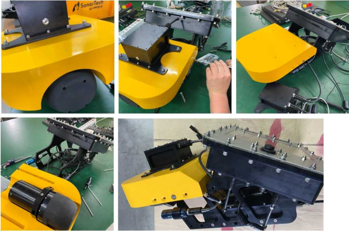
그림 3.120 개선된 부력재를 휴대용 다이버 영상장비 조립한 최종 형상
