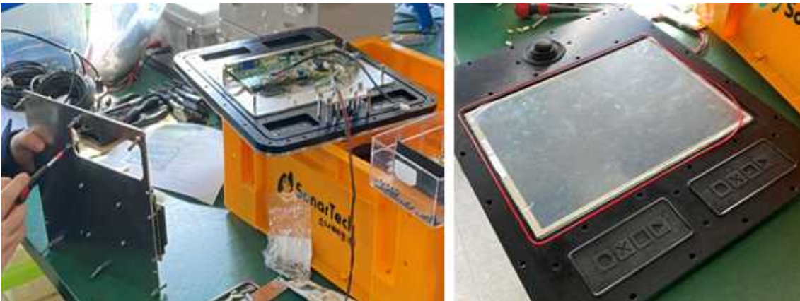
그림 3.53 휴대용 다이버 영상장비 제어를 위한 HID 보드, 조이스틱 그리고 키보드 제작
