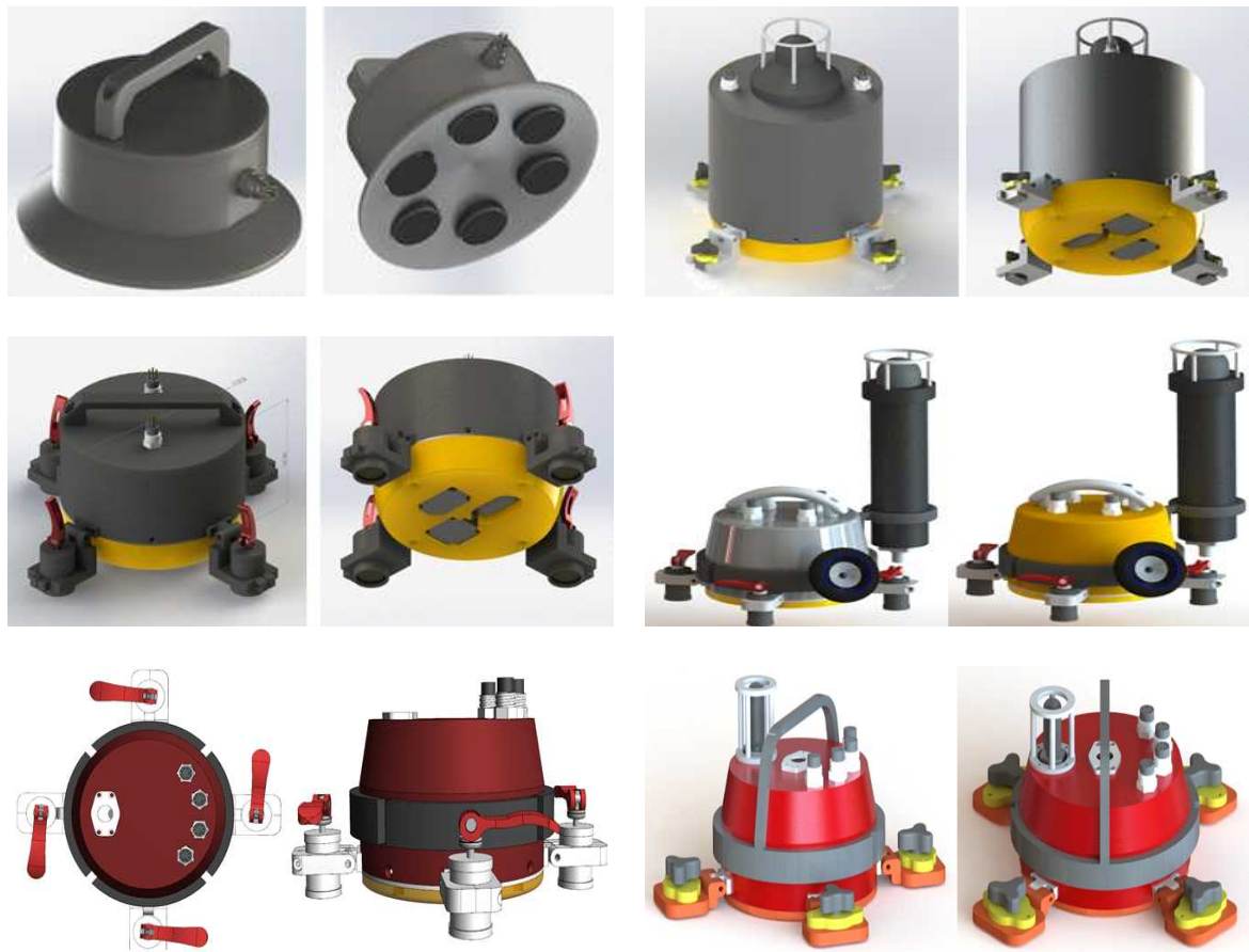
그림 3.13 선체 부착형 청음시스템을 위한 3D 형상 변경 과정
