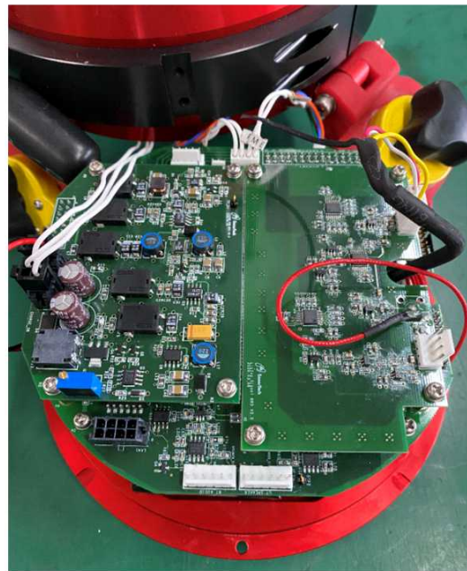
그림 3.84 청음장치용 (상) Main Board의 수신부와 디지털부를 분리한 보드 제작과 (하) PCB 보드 장착 결과
