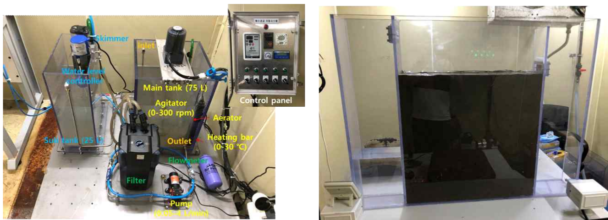
그림 3-2-13. 자동해수유통 시스템(왼쪽)과 퇴적물 안정화(오른쪽)
