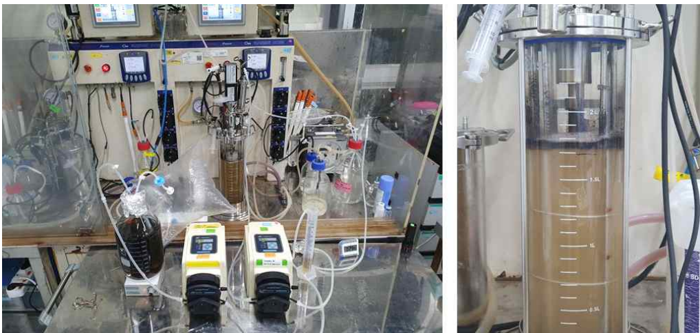
<그림 2-2-1. Clostridium sp. AWRP의 CO 2 전환을 위한 연속 배양기 (좌) 및 실제 배양 사진 (우) >
