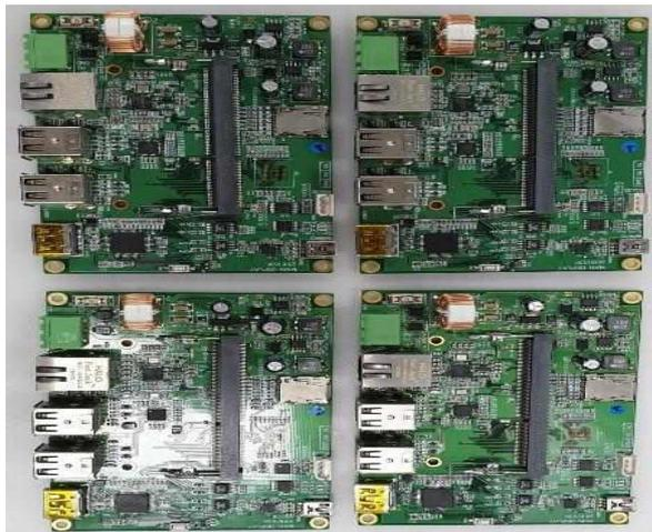
그림 64 다중프로토콜 통신 인터페이스 PCB 조립
