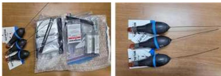
그림 56 방어 실해역 tracking monitoring을 위한 mini-PAT
