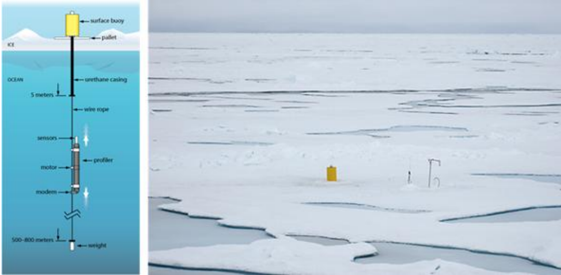
그림 2-2-6. ITP의 모식도와 현장에 설치된 모습 ( http://www.who.edu/page.do?pid=20756 ).
