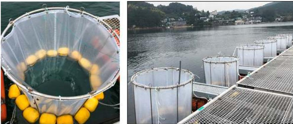
그림 3-1-1. 야외 메조코즘 설치 사진
