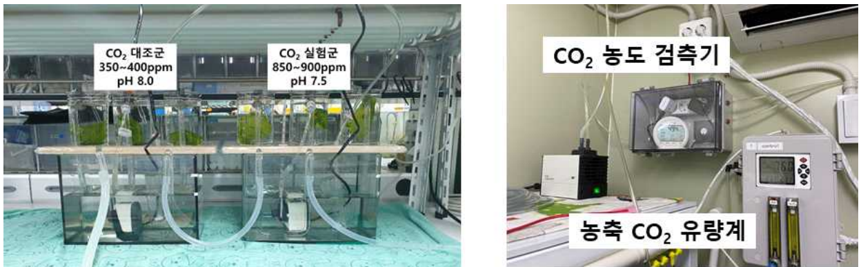
그림 5. 산성화 실험 실내 실험 시스템(좌)과 CO 2 농도 검측기 및 농축 CO 2 조절 유량계(우)
