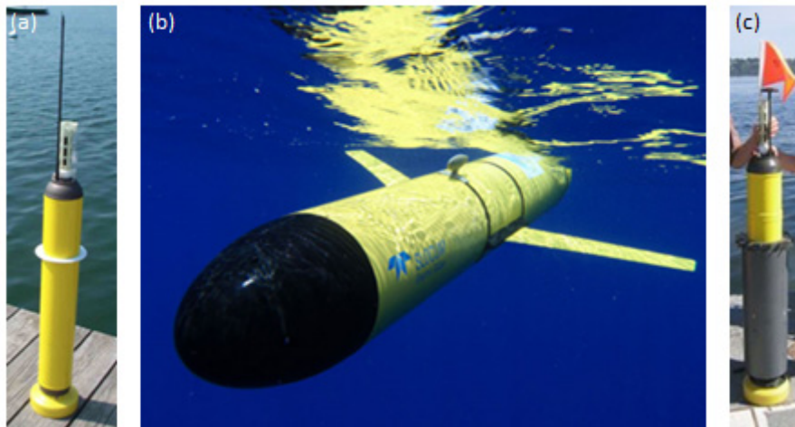
[그림 4-3-2] 널리 활용되고 있는 해양 무인관측기기 (a) 아르고 플로트 (b) 수중글라이더 (c) EM-Apex
