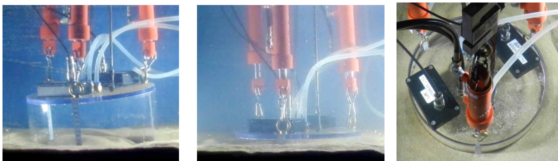
(a) 관입전 (b) 관입후 (c) 최종관입시 수직도 그림 2.27 석션관입시 리프팅케이블 개별 제어에 의한 수직도 보정 과정 (케이블 세줄)
