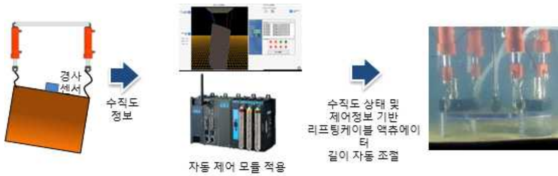
그림 3.36 수직도 제어정보시스템과 리프팅케이블 액추에이터 제어모듈 연계 개념도
