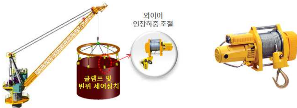
그림 2.3 윈치를 이용한 수직도 제어 시스템
