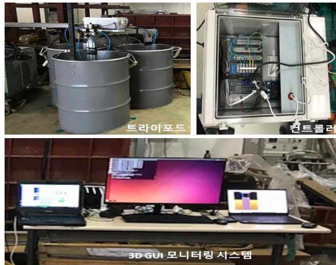
그림 3.23 수직도 제어정보시스템 모형실험 검증
