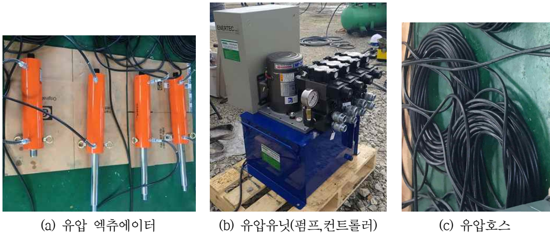
그림 2.41 제작된 유압 액추에이터 및 구동 시스템
