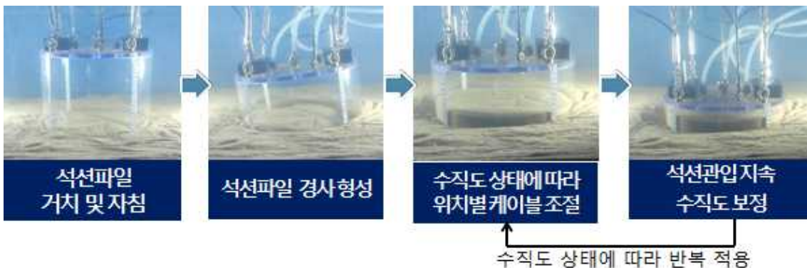
그림 2.17 케이블 개별 제어에 의한 수직도보정 효과 분석을 위한 석선파일 모형실험 방법
