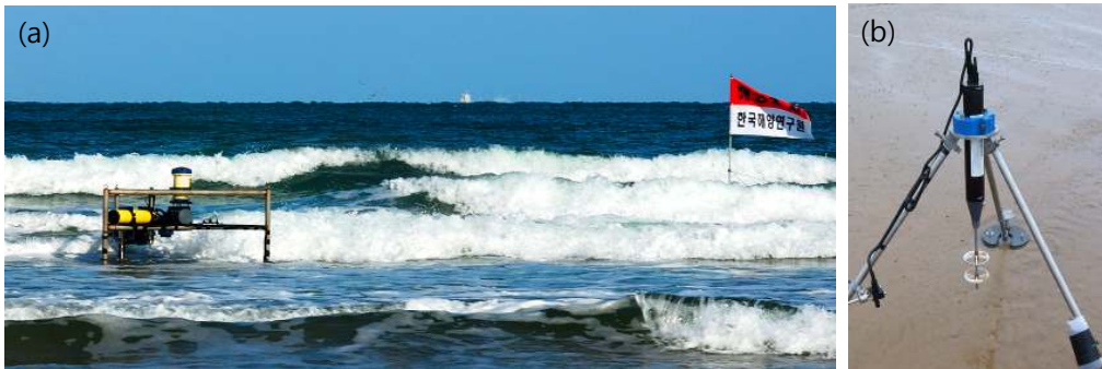
그림 4.1.15 수리·퇴적현상 정밀관측시스템 SPHINX(a) 및 MAVS(b)
