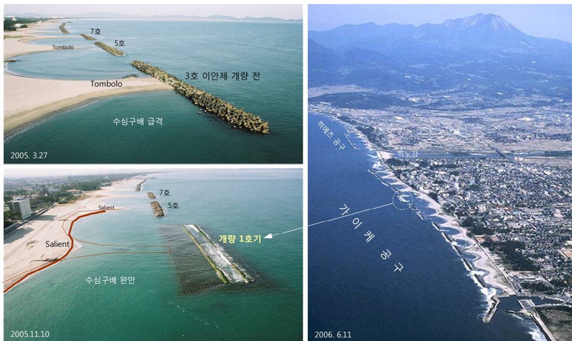
그림 3.3.15 가이케 해안 제3호 이안제 Crest형 잠제로의 개량전후(日野川河川事務所 2007)
