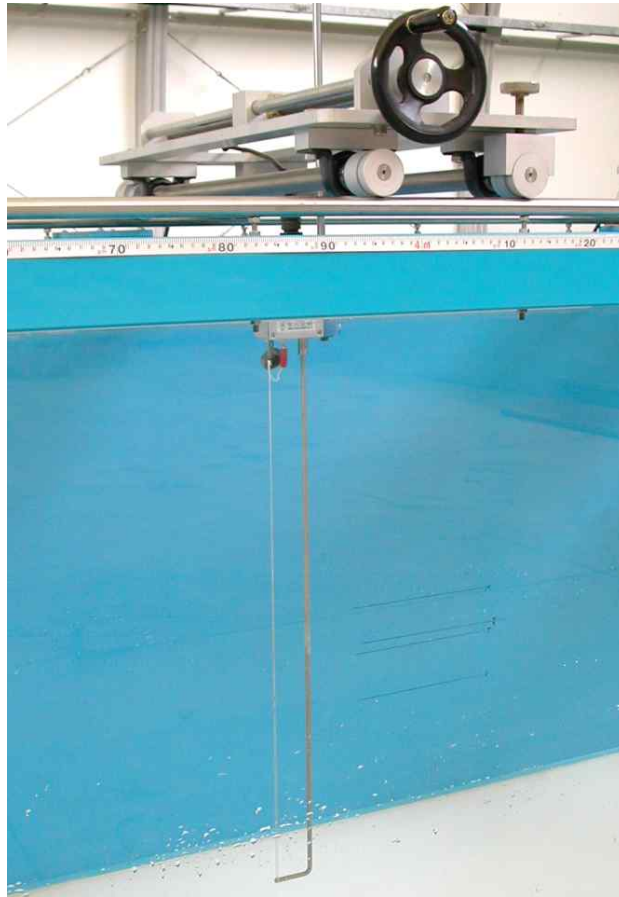
<그림 3-3-1-10> 파고계를 대차에 고정시킨 모습
