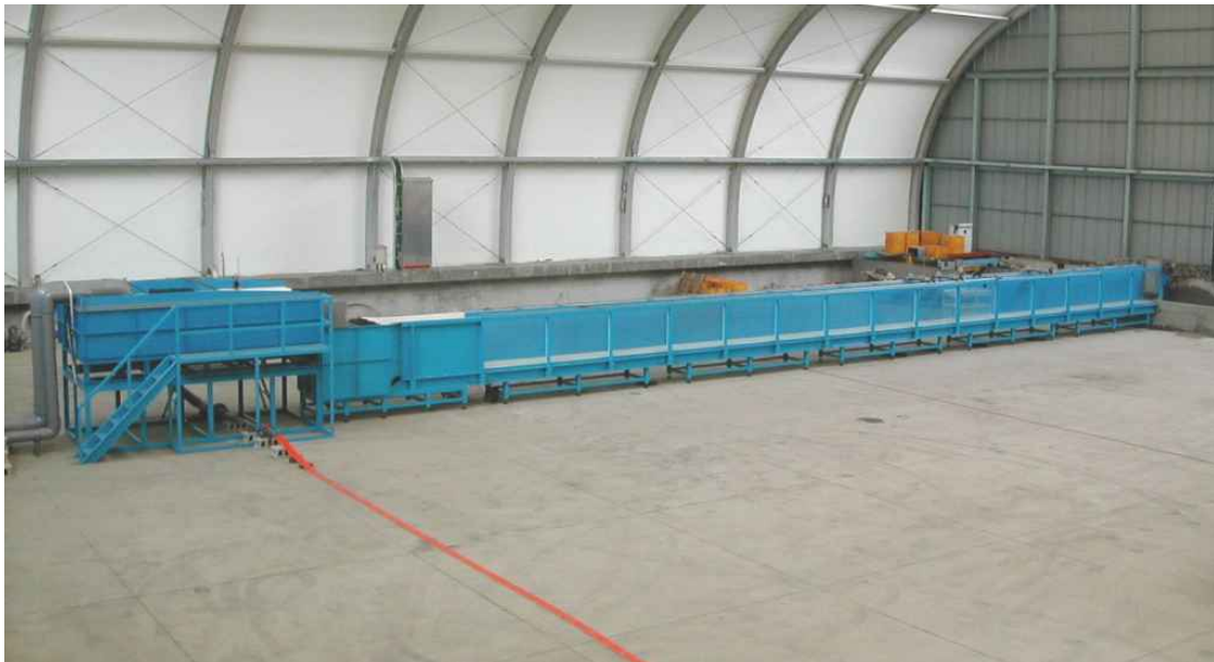
<그림 3-3-1-1> 평면수조실에 설치된 개수로시스템의 전경
