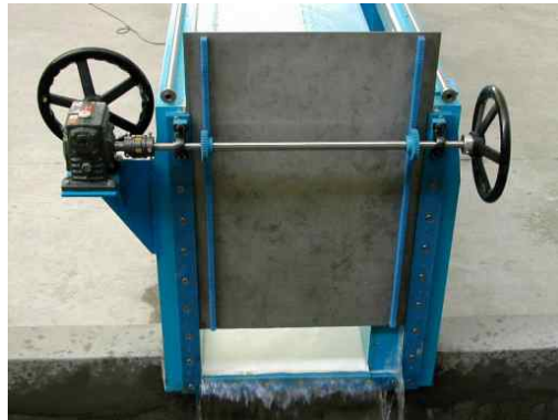
<그림 3-3-1-6> 관측수로 후면 수위조절장치 및 감속기어
