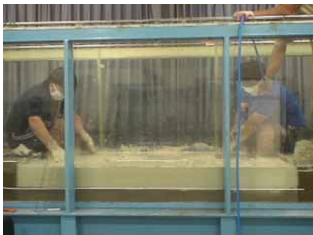
그림 4.2.20 상부 점토 20cm 지반 조성 장면
