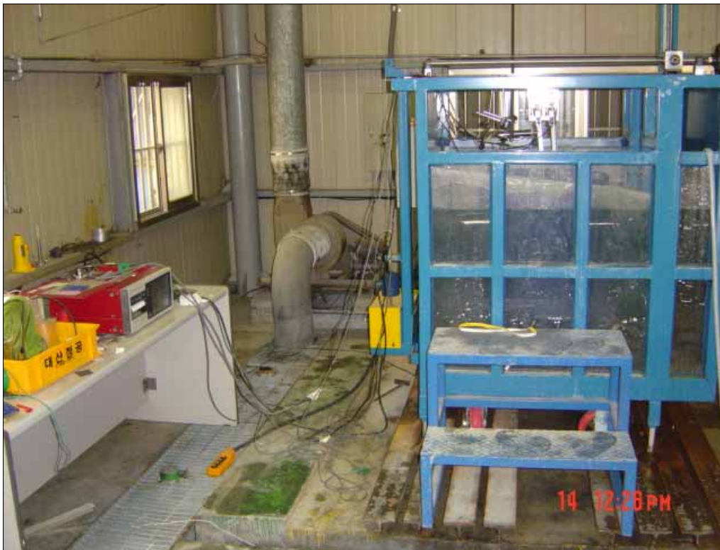
그림 4.1.28 횡방향 하중재하실험의 모습
