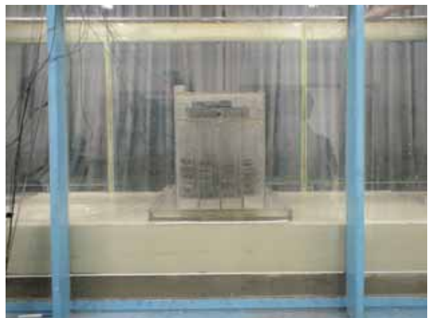
그림 4.2.20 상부 점토 20cm 지반 조성 장면
