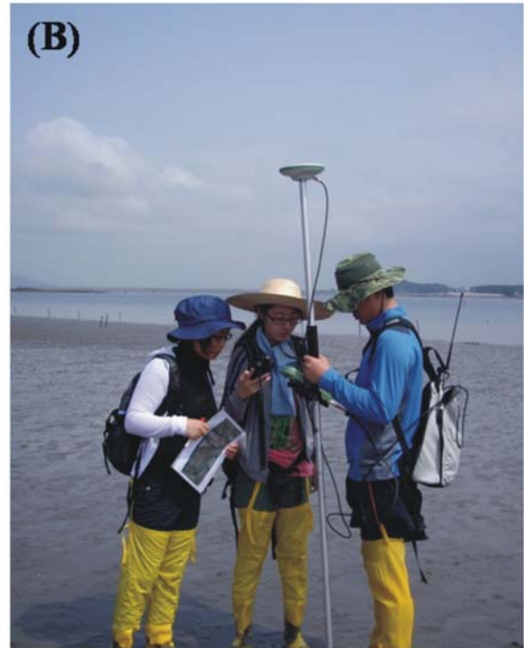
그림 6. RTK GSP 설치 및 갯벌 지형 고도 측정
