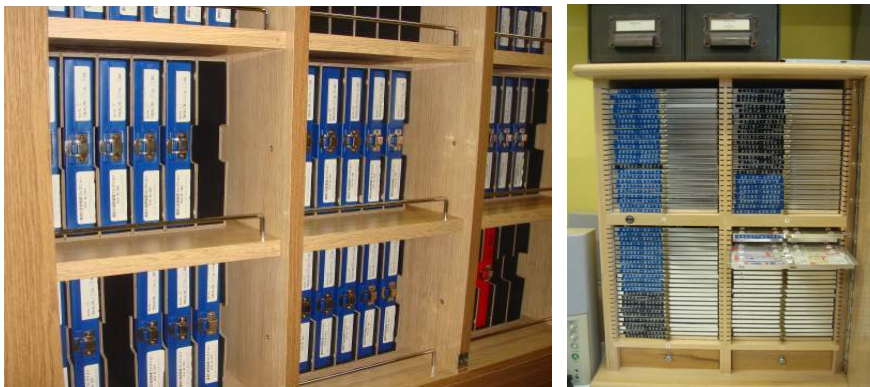
그림 4-12. 원생생물의 표본 슬라이드의 box 배열(좌측 : 수직으로 세워서 보관[안의 표본 슬라이드는 수평], 우측 : 슬라이드 rack을 서랍식으로 빼고 넣고 하는 방법).
