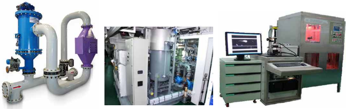
[시료 채취에 적용 가능한 국내 선박평형수 처리 장치 (좌부터, 광산, 현대중공업, 21세기 조선)]
