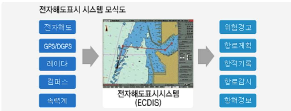
그림 3-1-29 전자 해도 표시 시스템 모식도
