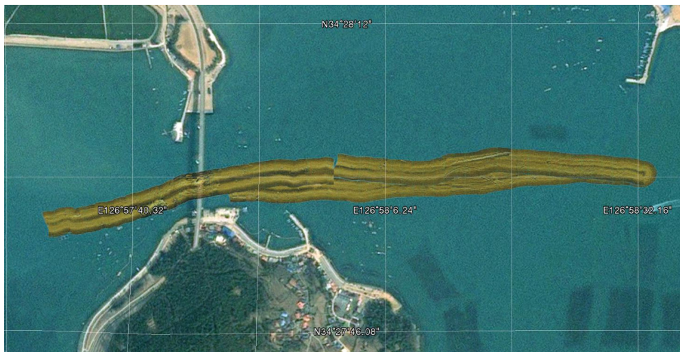
[소나테크의 측면주사소나를 이용하여 모자이크한 노력도 인근 해저면 형상]
