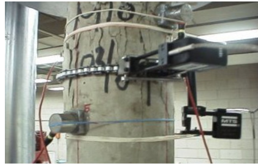
[음향 탐상법을 이용한 콘크리트결함 검색]
