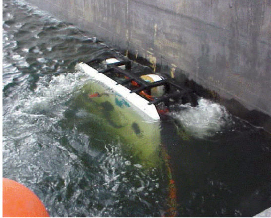
[워터젯을 이용한 선저청소로봇 (노르웨이 CleanHull사)]
