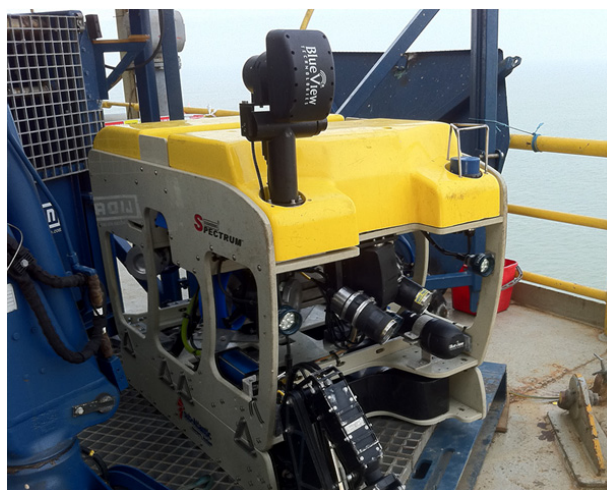
[ROV에 3D 멀티빔 스캐닝 소나 탑재 모습]
