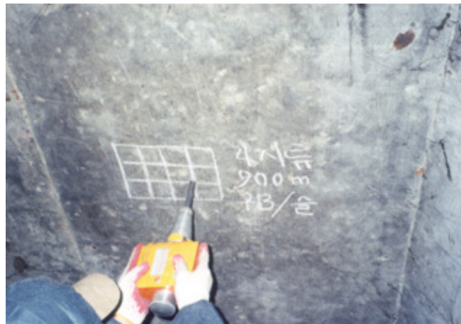
[슈미트 해머 및 슈미트해머를 사용한 콘크리트 강도 측정]
