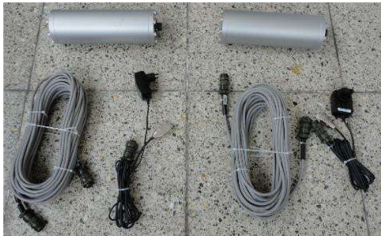
그림 2.2.17 제작된 Depth 센서 방수시스템
