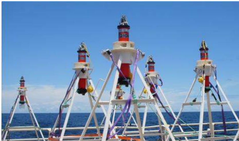
그림 3.4.2 Transponders for precise positioning(Sonardyne)
