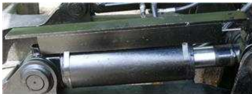
그림 5.2.10 고르기 툴에 장착된 LVDT 센서
