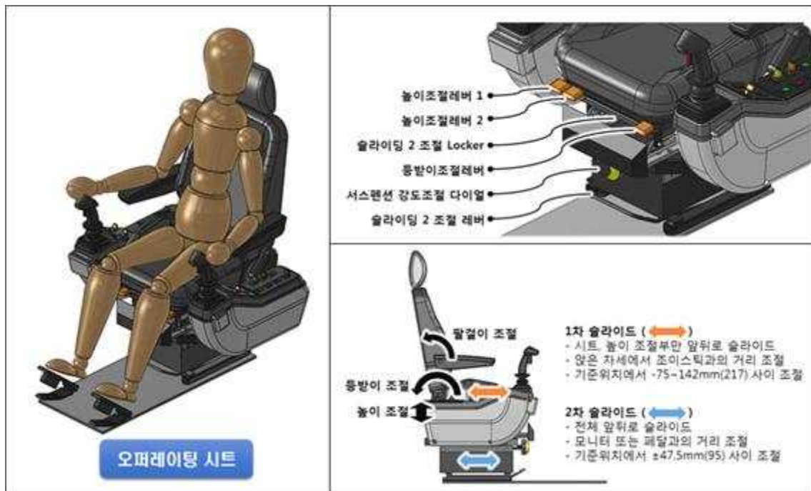
그림 5.1.3 오퍼레이팅 시트 설계결과 및 기능구성
