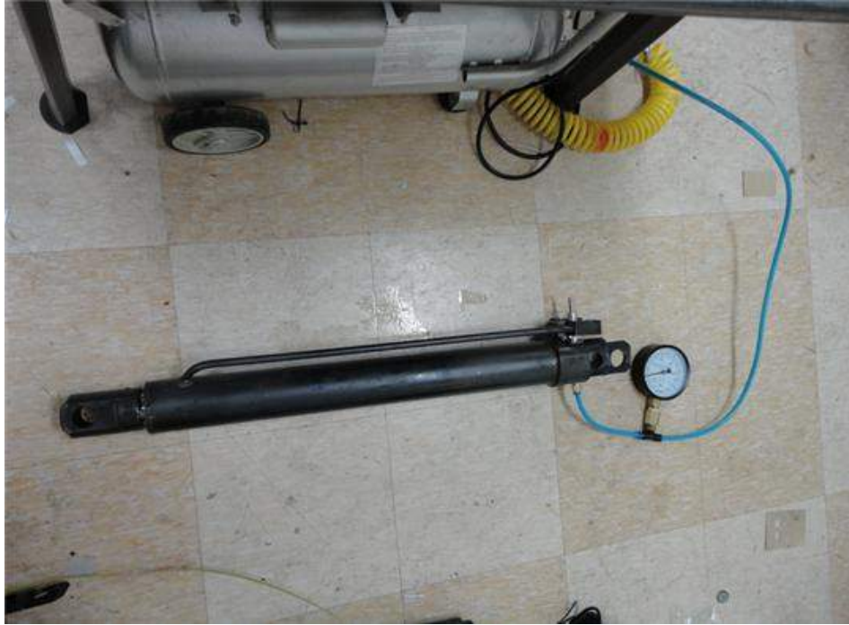
그림 2.2.6 아우트리거 서보 실린더의 방수 성능 시험
