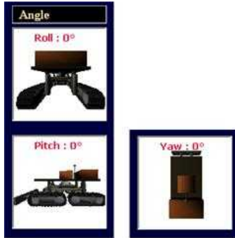
그림 4.1.9 Roll/Pitch/Yaw에 따른 장비 형상 표현
