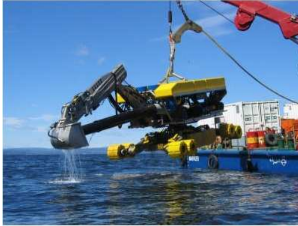
그림 2.5 해저용 원격조정 굴삭기(Nexans Spider ROV)
