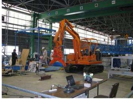
그림 2.3.4 이형블록작업용 툴 부착 장비 (일본 PARI)
