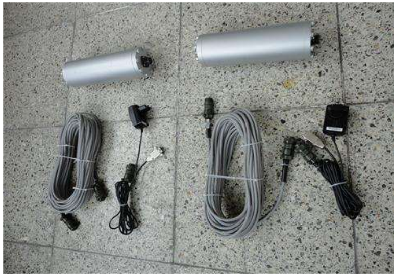
그림 3.3.4 방수 처리된 Depth Sensor
