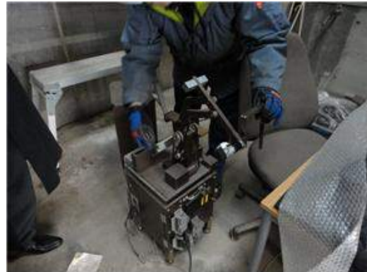
그림 1.2.10 촉각인식을 이용한 백호 / 원격조종장치
