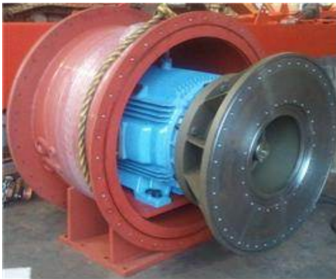
(a) 전동기 및 커플링하우징 조립
