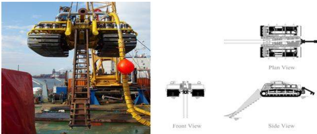
그림 2.3.10 워터젯 부착 장비 사례(Subtrencher-2)
