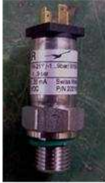
그림 2.5.14 오일탱크 공기압력 측정을 위한 압력센서
