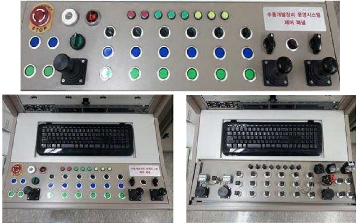
그림 4.2.7 제어 패널 설계 및 가공 제작
