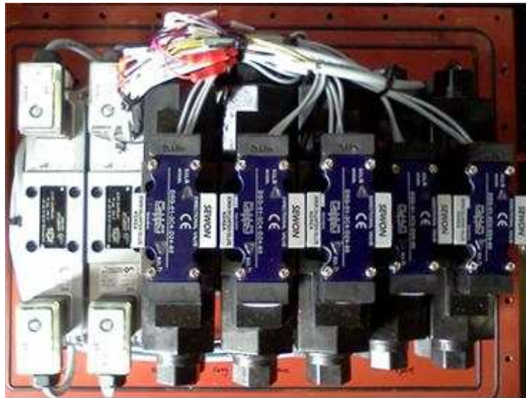
(b) 프로포셔널 및 솔레노이드 밸브 블록 제작
