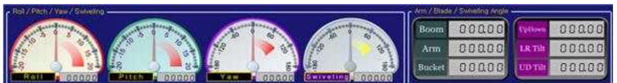
그림 4.2.2 장비 자세 및 블레이드, 암 각도 표시부
