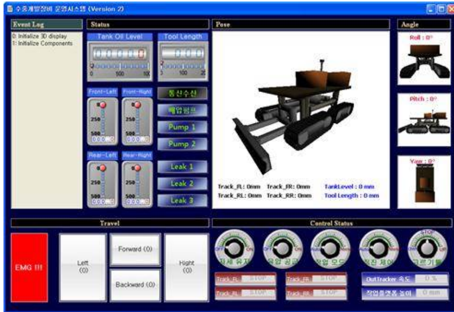
그림 4.1.6 운영시스템 소프트웨어 GUI 프로그램 구성
