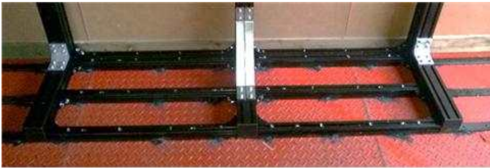
그림 4.1.6 다중 모니터링 시스템의 컨테이너 고정부 사진
