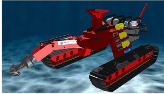
그림 6.11 지반 굴삭장비 - Subsea mining
