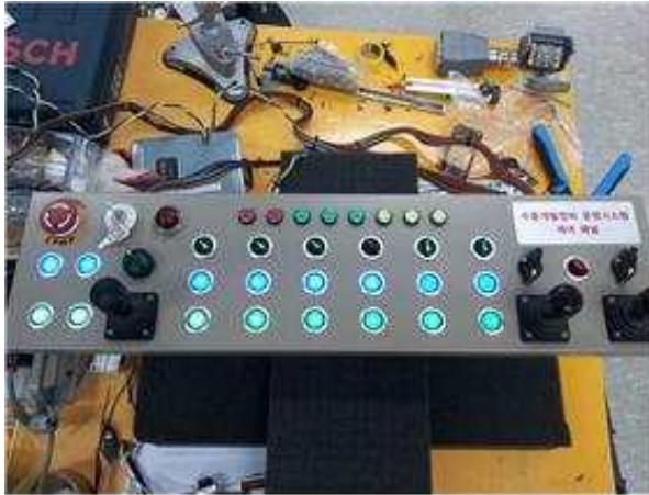
그림 4.2.10 제어패널 통합 테스트 및 기능 동작 확인
