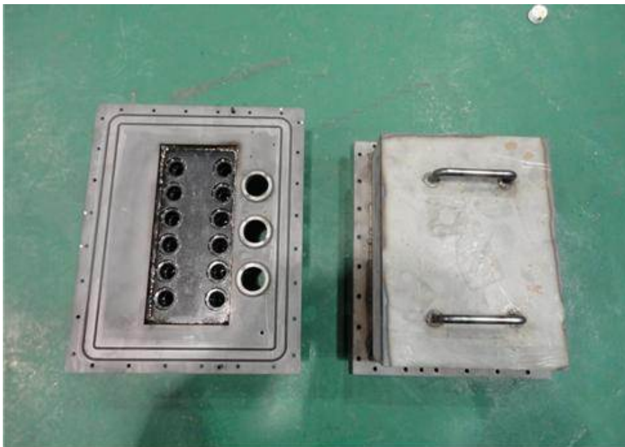
그림 2.2.9 제작된 파일럿 제어용 서보 밸브 방수 케이스
