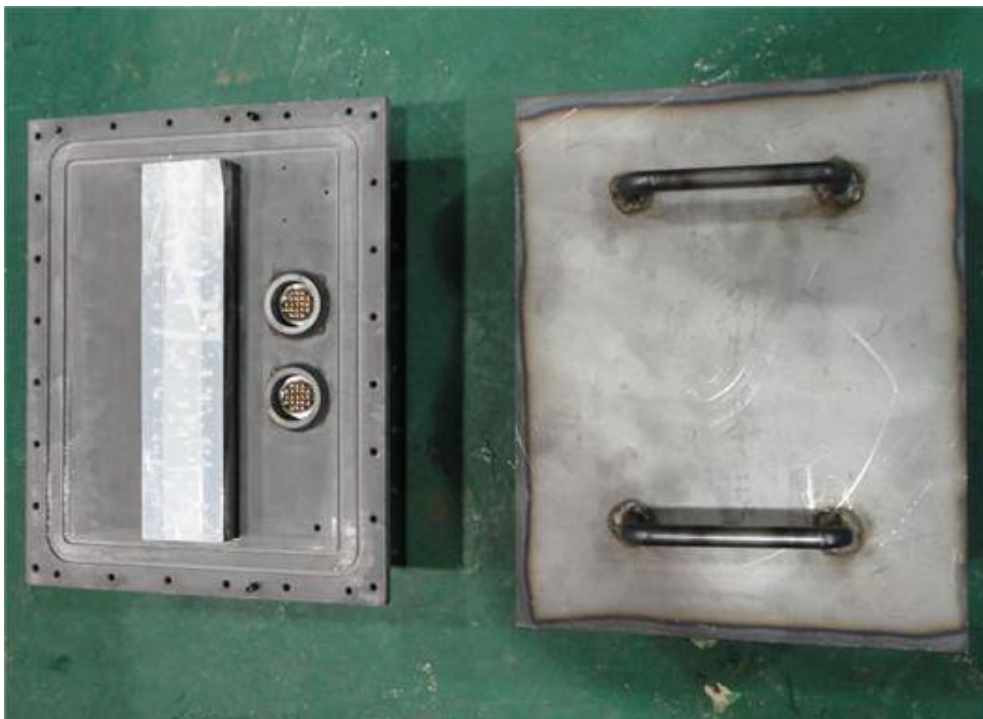
그림 2.2.11 제작된 솔 밸브 방수 케이스
