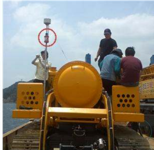
그림 3.1.4 LBL transceiver installed on rock paver
