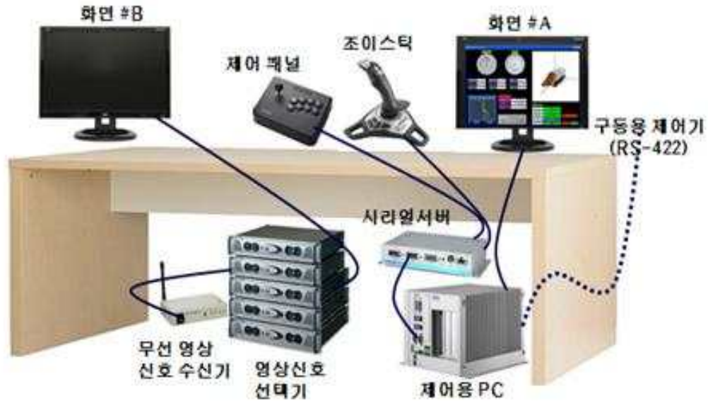
그림 4.2.1 시험용 원격제어 운영시스템 구성도
