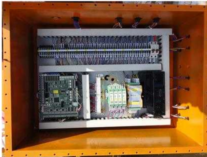
(b) 설치된 구동용 제어기 그림 5.1.4 제작된 방수형 구동용 제어기
