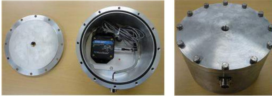
그림 2.2.14 제작된 레벨센서 방수 케이스
