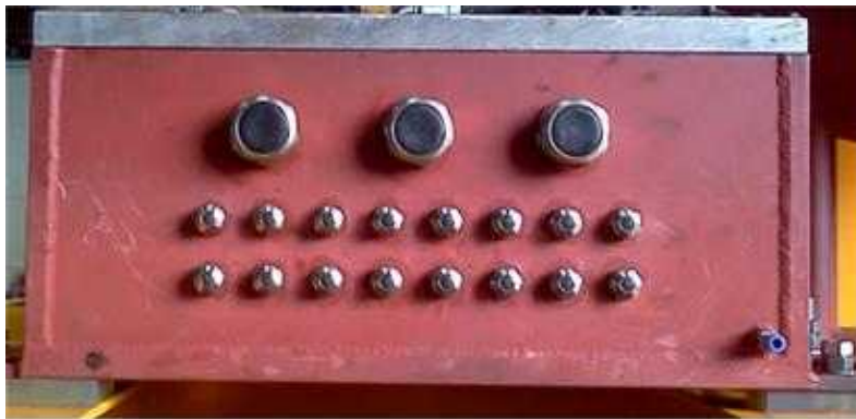
그림 2.2.14 제작된 구동판넬 방수 케이스
