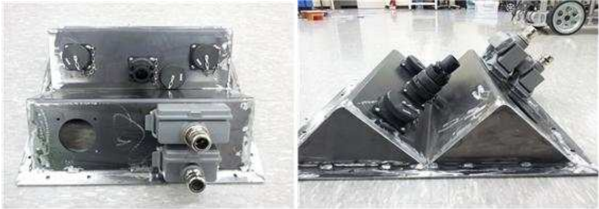
그림 4.1.4 전원 및 통신케이블 인입부 2차 설계 기구부
