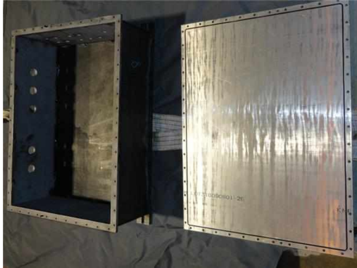
그림 2.2.19 제작된 구동용 제어기 방수 케이스
