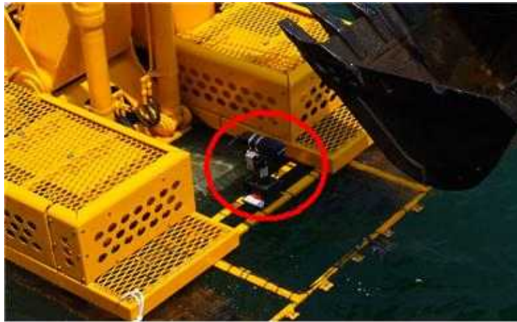
그림 3.3.9 Attached P900-90 and Pan&Tilt on the equipment
