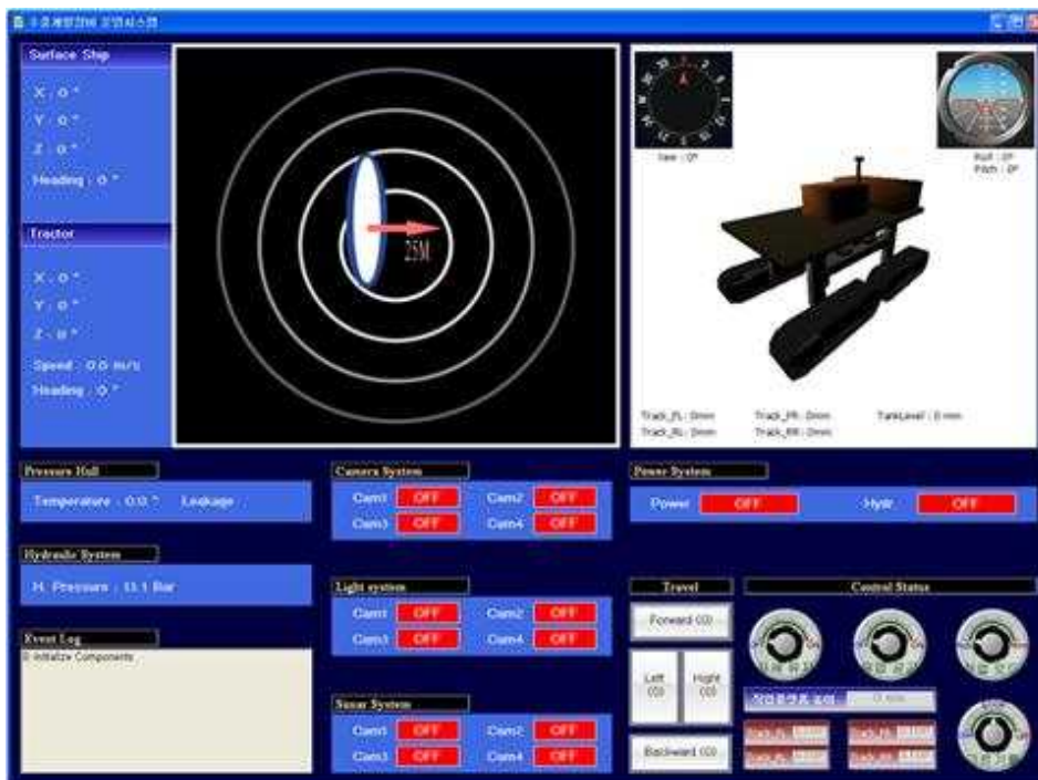
그림 4.2.6 시험용 원격제어 모니터링 GUI 프로그램 화면 구성도
