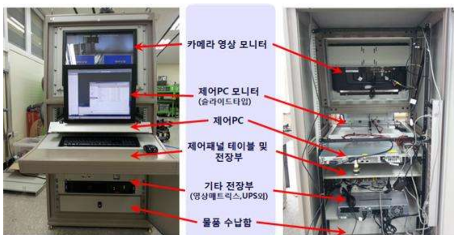
그림 4.2.2 콘솔 랙 내부 장비 배치
