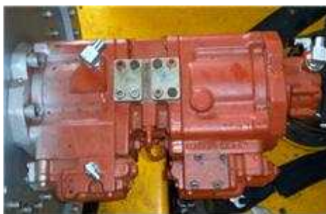
(a) 메인펌프 설치
