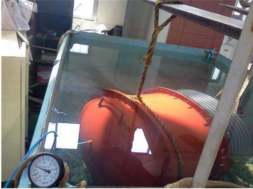
그림 1.1.19 전동기 방수 케이스의 방수성 실험
