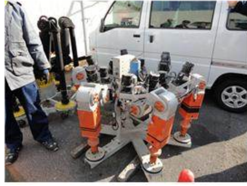
그림 1.2.7 연안 및 사석고르기 면 높이 측정용 보행 로봇
