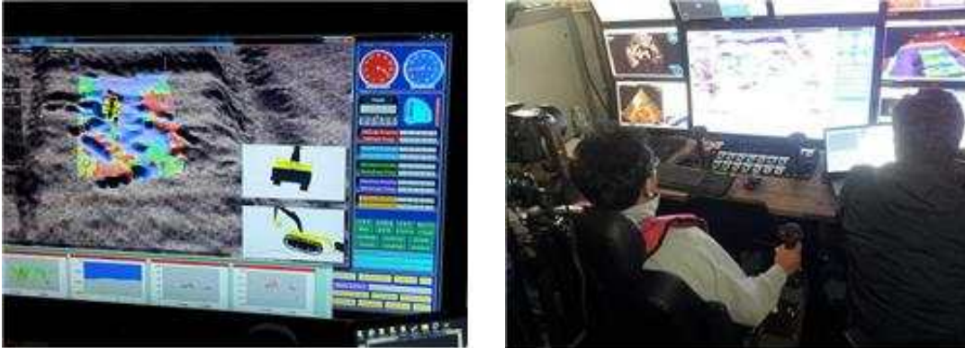
그림 5.3.3 위치 보간 필터 알고리즘이 실행되어 장비 위치를 표시
