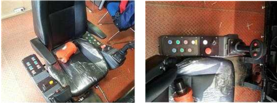
그림 5.2.6 오퍼레이팅 시트와 제어패널 통합 및 운용
