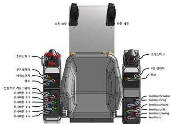
그림 5.2.3 오퍼레이팅 시트 제어패널 기능 배치도
