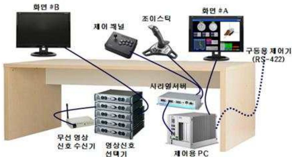
그림 5.2.12 시험용 원격제어 운영시스템 구성도
