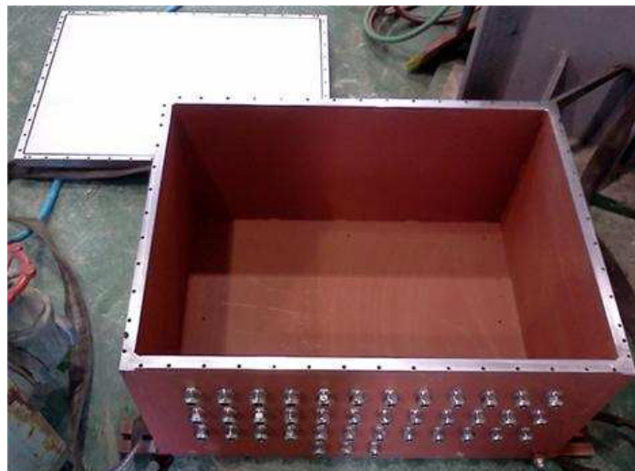
그림 2.2.11 제작된 제어기 방수 케이스
