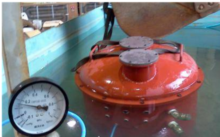
그림 1.1.22 수중 작동유 탱크 방수 실험
