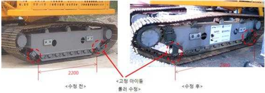
그림 1.1.1 트랙의 접지부를 넓힌 제작결과
