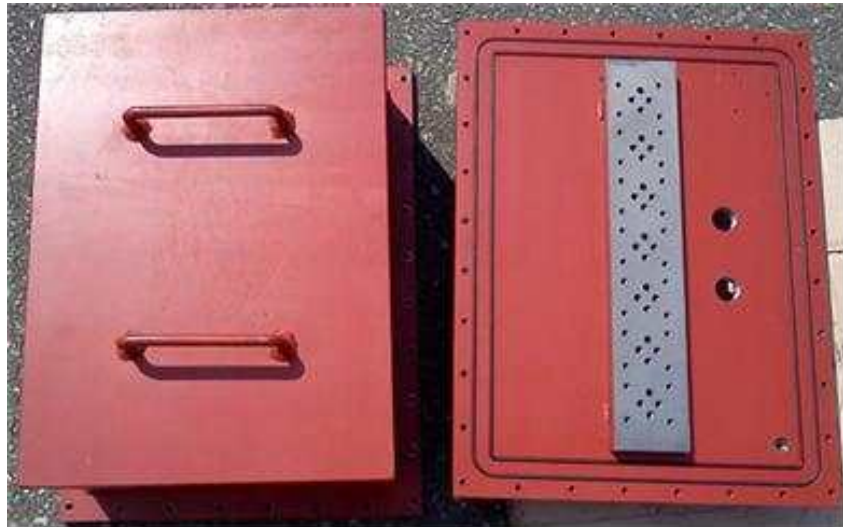
(b) 프로포셔널 밸브 및 솔레노이드 밸브 블록 그림 2.2.16 제작된 밸브 블록 방수 케이스 설계
