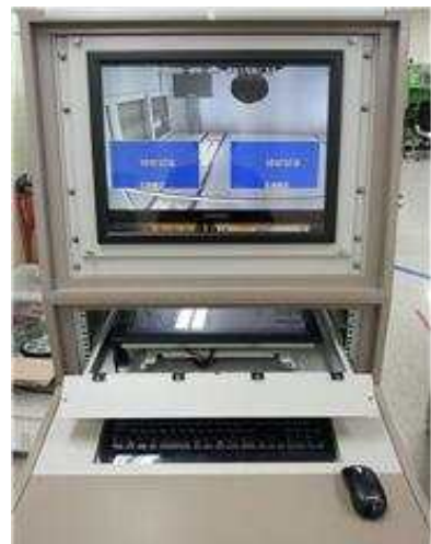
그림 4.2.4 제어 콘솔 랙 내 슬라이딩 방식의 디스플레이 설치
