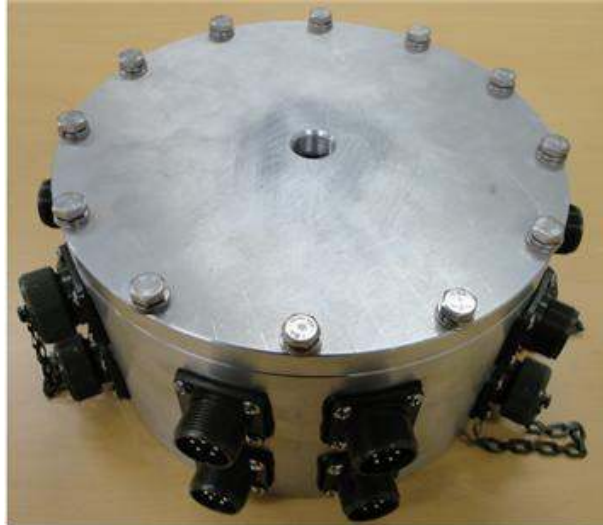
그림 2.2.16 제작된 카메라 정션 방수 케이스
