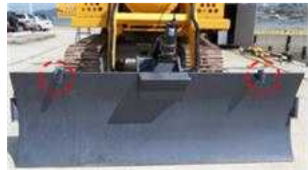
(c) 설치된 조명
