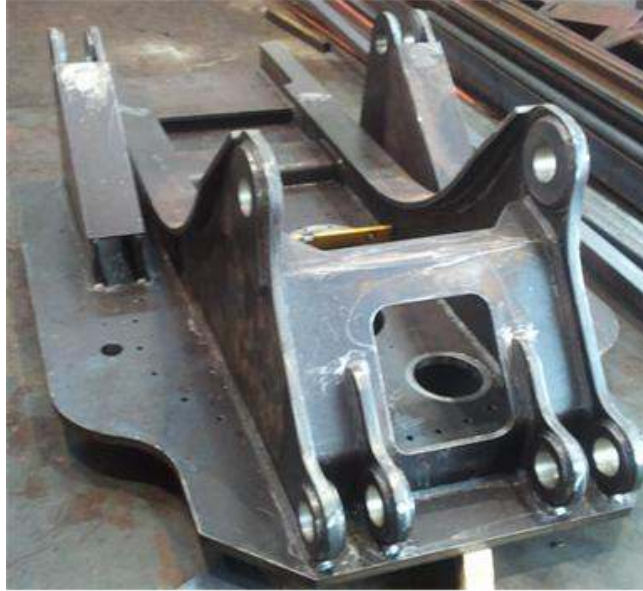
그림 2.2.2 상부 메인 프레임 제작
