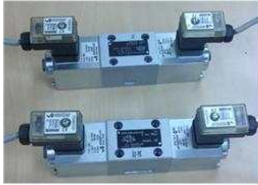
그림 2.5.11 블레이드 구동용 프로포셔널 밸브
