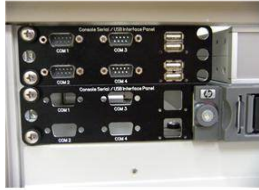
그림 4.2.3 RS232 시리얼 통신 포트 패널 1차 및 2차 제작
