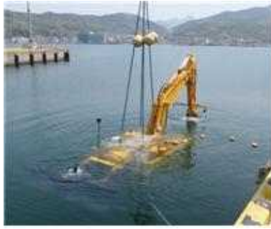
그림 2.2.3 장비 수밀 테스트
