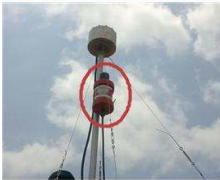
그림 3.1.4 LBL transceiver installed on rock paver
