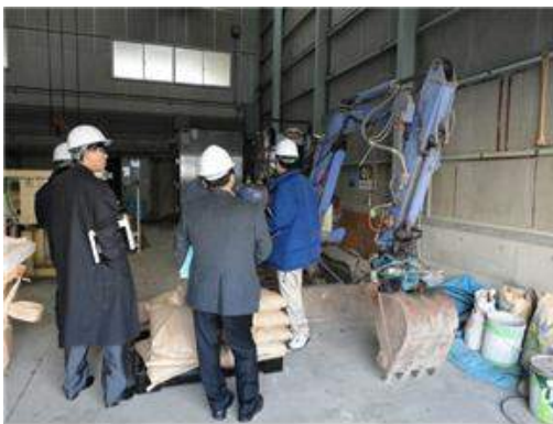
그림 1.2.10 촉각인식을 이용한 백호 / 원격조종장치
