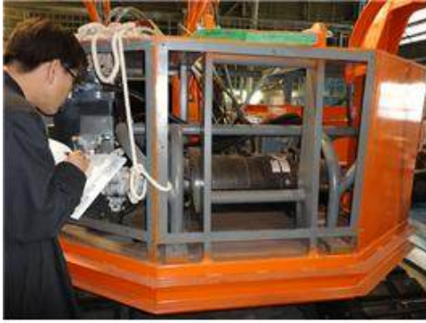
그림 1.2.9 수중 백호에 탑재된 전동모터 및 전동모터 Panel
