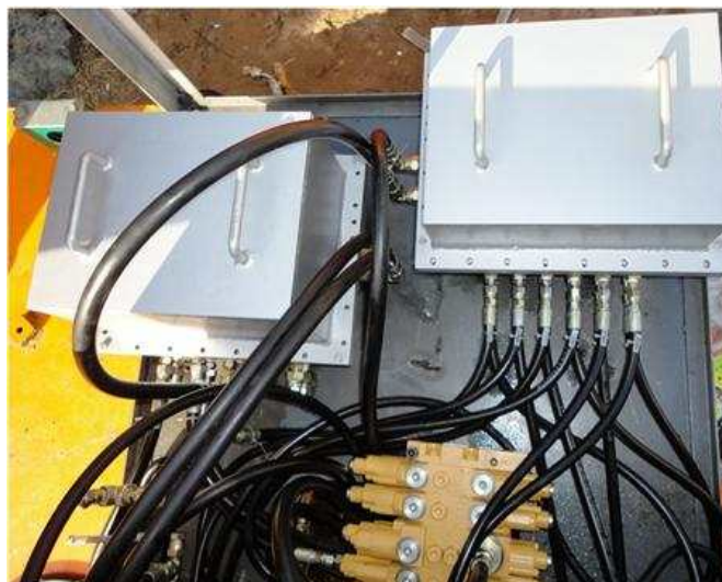
그림 5.1.2 설치된 파일럿 서보 밸브 및 솔 밸브 방수 케이스
