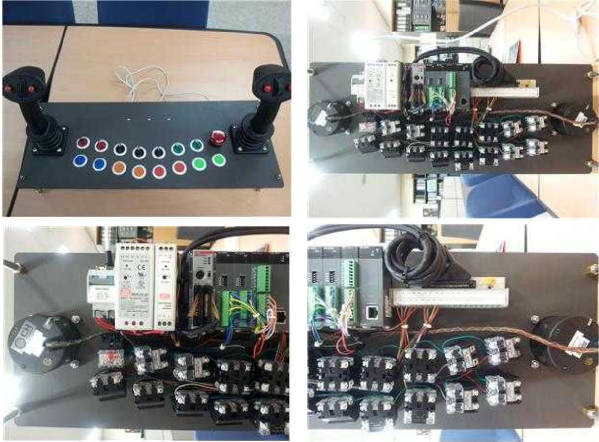
그림 4.1.8 수중고르기장비 사양을 반영한 제어 패널 (1차 버전)
