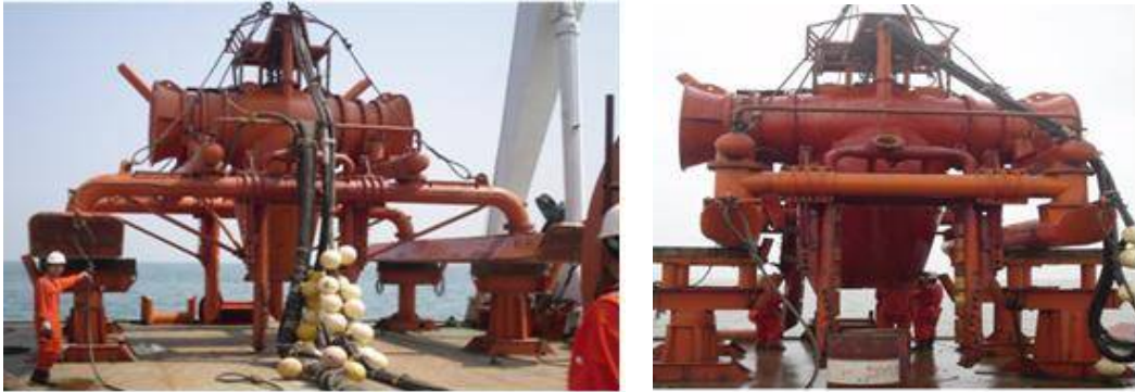
그림 2.3.8 워터젯 부착 장비 사례(T Type Trencher)
