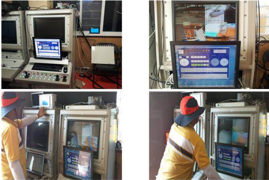
그림 4.1.8 수중 고르기 장비와 운영시스템 간 연결 및 조작 제어 테스트
