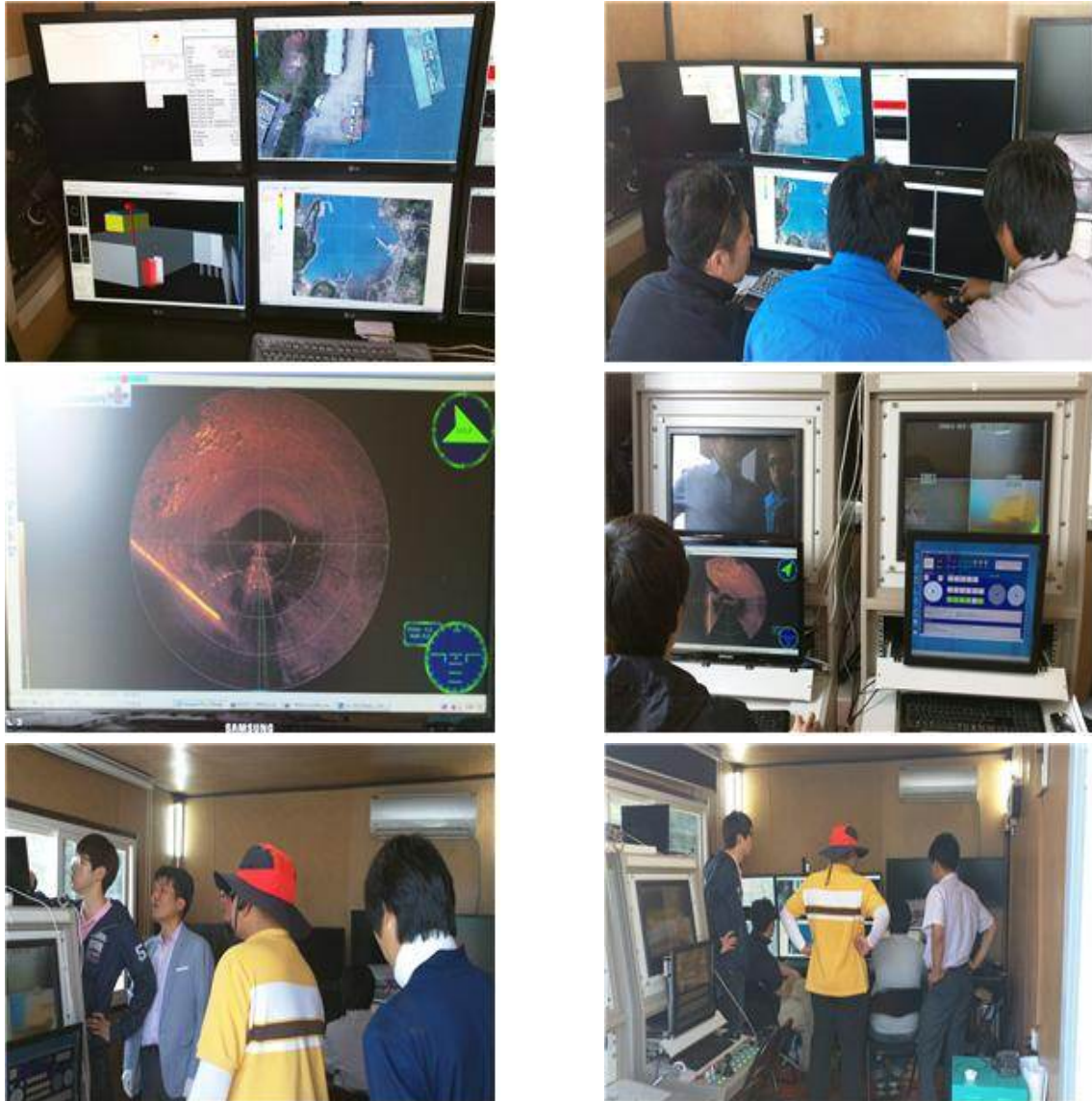
그림 4.1.9 수중환경 모니터링 시스템 및 이미지 소나 시스템 운용
