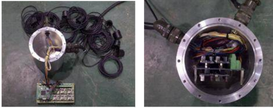
그림 2.5.30 방수케이스에 설치된 Altimeter
