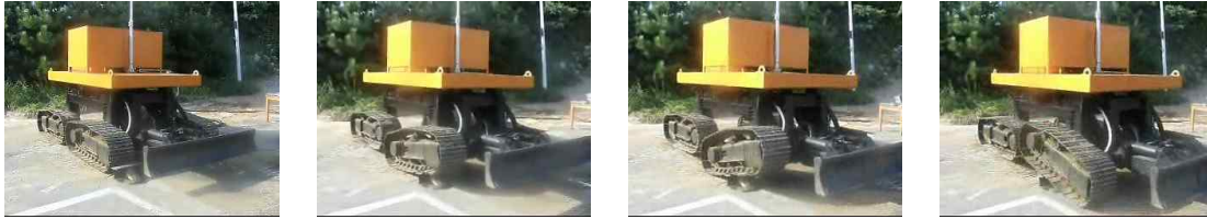
(a) 수평유지 제어 시 장애물 통과 장면 그림 6.1.9 작업플랫폼 높이제어 (수평유지)
