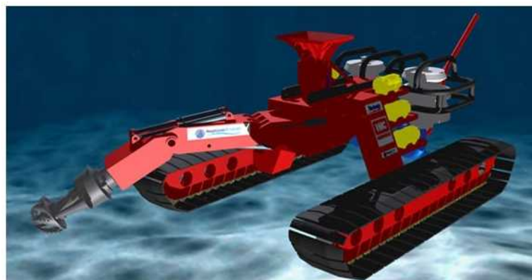
그림 2.9 지반 굴삭장비 - Subsea mining
