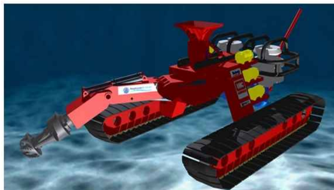
그림 1.2.20 지반 굴삭장비 - Subsea mining
