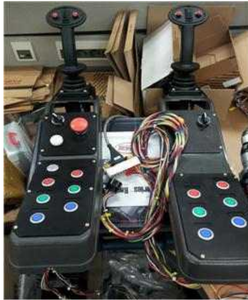
그림 5.2.4 제어패널 전장부품 배치 및 실장
