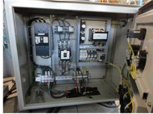
그림 1.2.9 수중 백호에 탑재된 전동모터 및 전동모터 Panel
