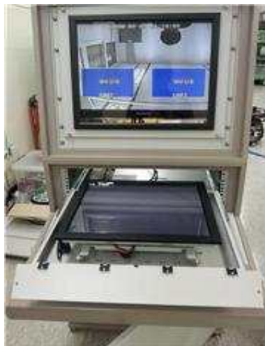
그림 4.2.4 제어 콘솔 랙 내 슬라이딩 방식의 디스플레이 설치
