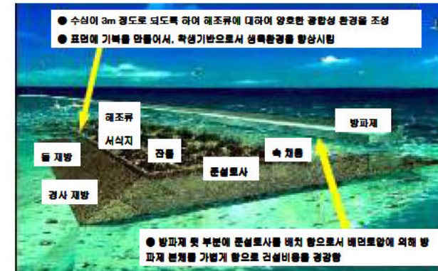
그림 1-4. 일본의 해양오염퇴적물 재활용 사례(방파제 조성) 20)
