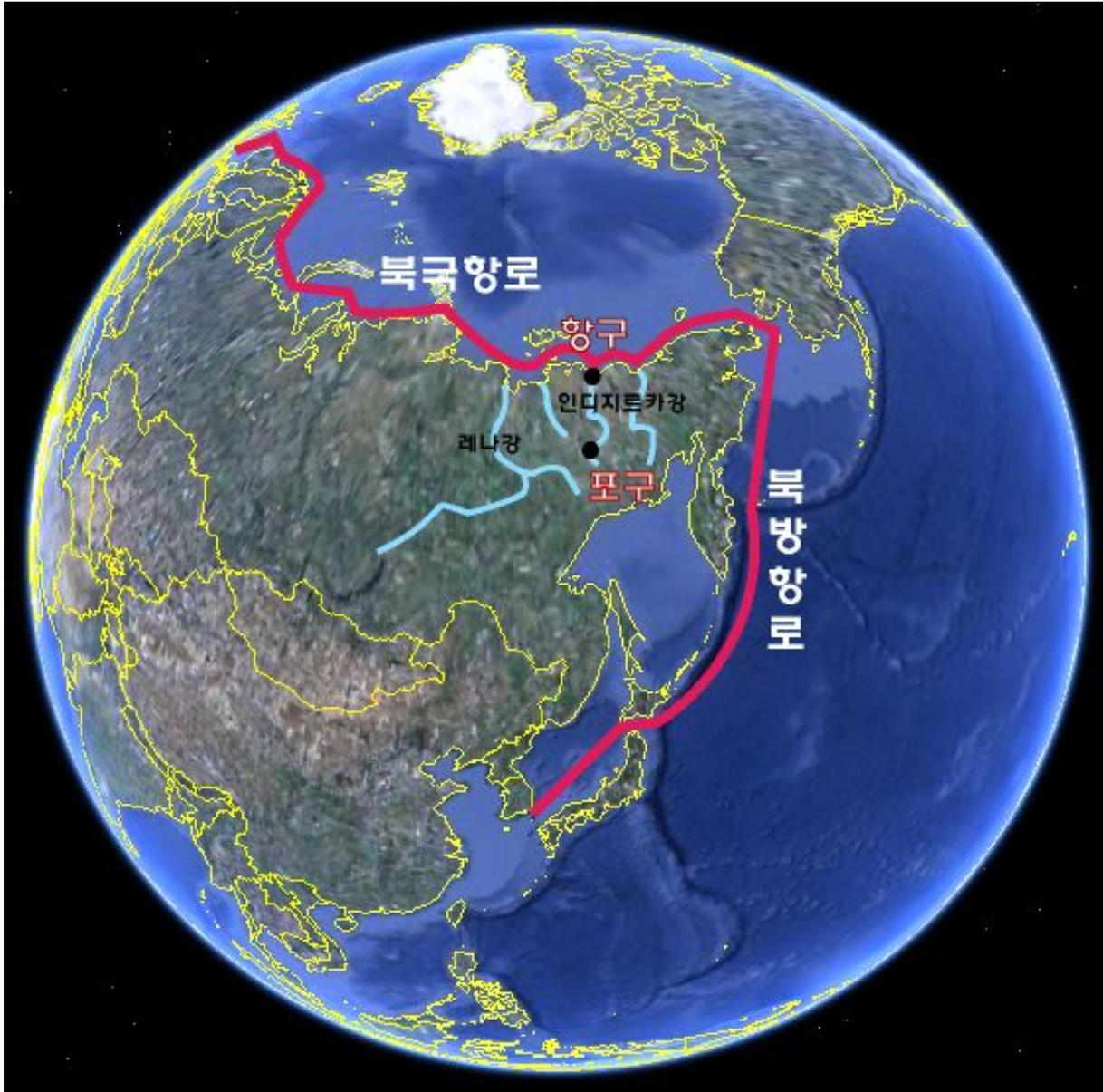
그림 3.39. 제시된 부산-북극연안 운송시나리오. 동시베리아 자원개발시 개발대상지까지 자재, 장비, 인력을 운반한다든지 개발된 원자재를 수요처까지 실어 나르기 위한 운송 최적 시나리오는 하천과 북극해 항로를 결합시키는 것으로 강 상류에 강변 기지인 제1집하장(포구)을 건설하고 이곳에 개발된 자원을 모아 하구에 건설된 해상 기지인 제2집하장(항구)으로 강을 통해 이동시킨 후 북극해를 이용하여 운송하는 방법이다. 만약 북극해 얼음이 녹는 여름철(3개월)에 하천과 해상을 이용한다면 극동시베리아에서 개발된 광물자원을 부산까지 실어 올 수 있고 총 소요일수는 왕복 57일로 추정된다.
