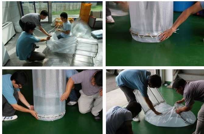
그림 3-37. 메소코즘 유닛 조립 및 누수 테스트
