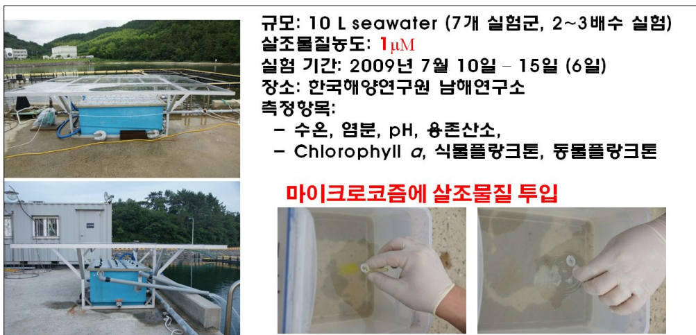
그림 3-30. 연구어장에 설치된 현장 마이크로코즘 시스템과 부유생태계 위해성 평가법
