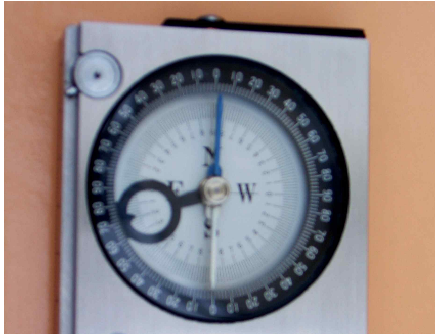
<그림 3-2-7> 여초 등표 현장조사 사진 - 등표기울기 계측
