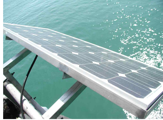
(b) 설치된 태양광 발전판
