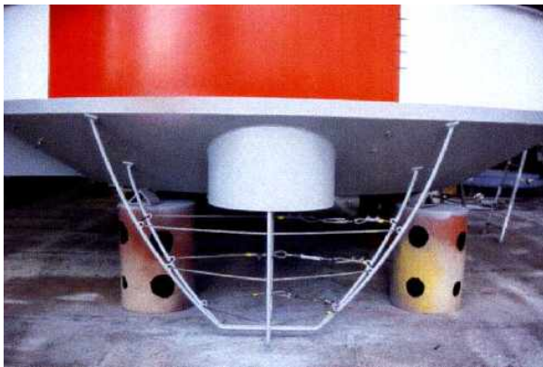
<그림 2-2-4> 등부표에 설치된 조류발전장치
