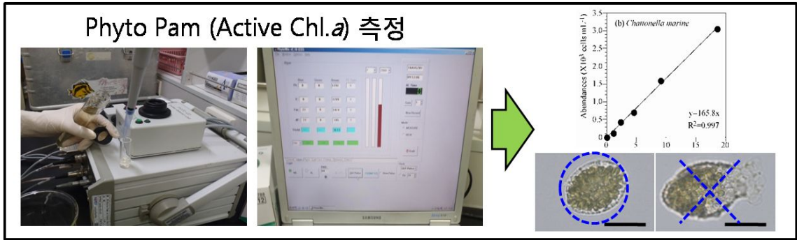
그림 3. 4. 4. Methods of active Chl.a measurement using Phyto PAM. 모든 실험에서 형광광도계로 측정된 값과 각 종의 세포밀도와의 관계식으로 FSU값에 대한 각 종에 대한 개체수밀도를 파악하였음(그림 3. 4. 5 and 그림 3. 4. 6).
