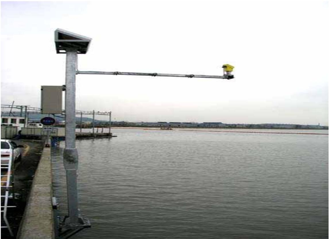
그림 2.1.2 레이더식 실시간 해수위계 설치 사진.
