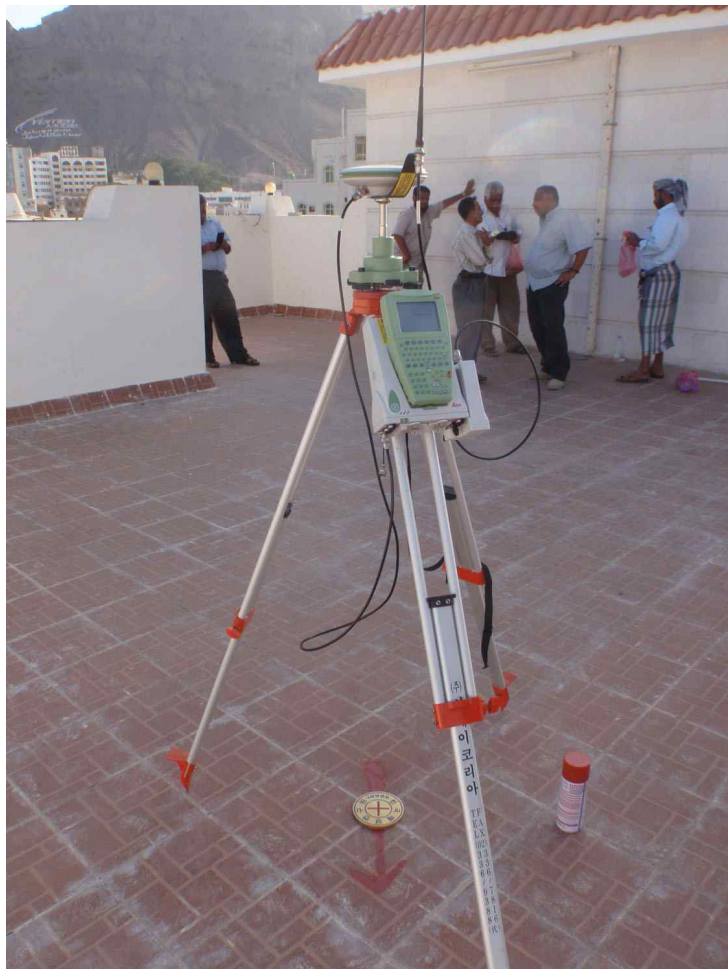
Fig. 3-18. 아덴 광물자원청 건물 옥상에 설치한 지형조사 기준점
