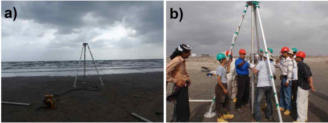
Fig. 3-22. 해변에서의 진동 시추채취기 설치(a)와 퇴적물 채취 실습(b)
