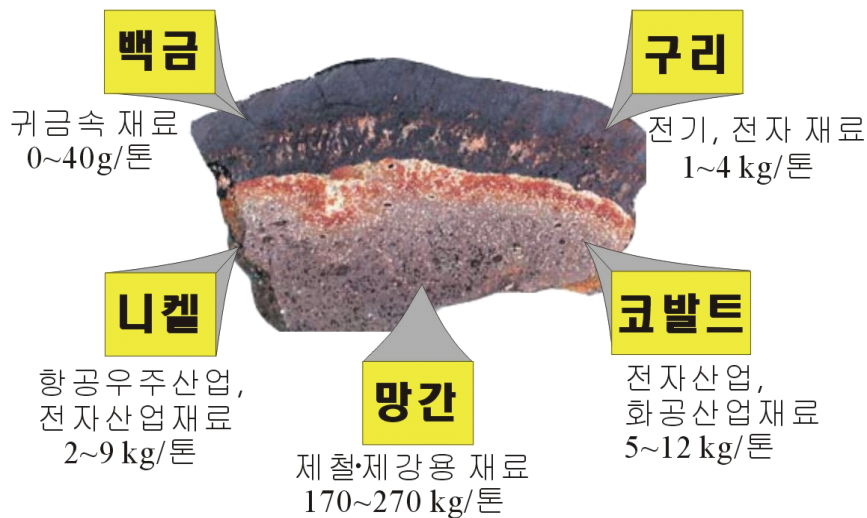
그림 42. 해저산에서 채취된 망간각, 분석을 위해 절단된 약 20 cm 두께의 망간각, 단면에서 층리를 이루는 성장조직이 관찰된다.
