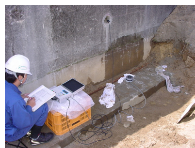
〈SRI-CM-3에 의한 자연전위 및 분극저항 현장 측정사례〉
