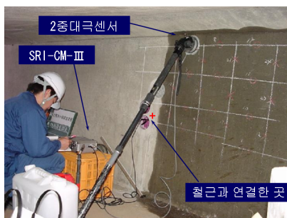
〈SRI-CM-3에 의한 자연전위 및 분극저항 현장 측정사례〉
