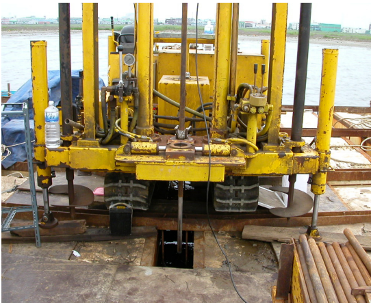
〈Pontoon barge 위에서 수행중인 해양콘관입시험〉
