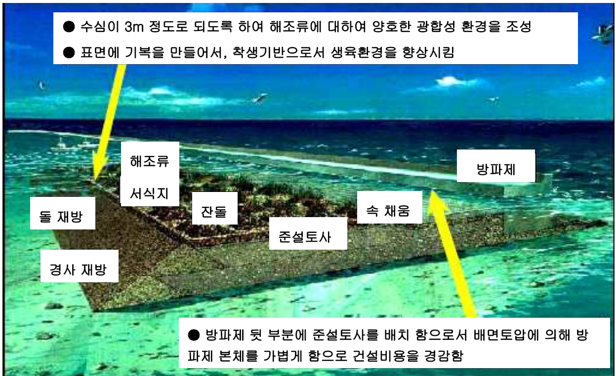
그림 1.6 케이싱 공법을 이용한 수저준설토 유효활용 (일본 쿠시로 항, 방파제 조성)
