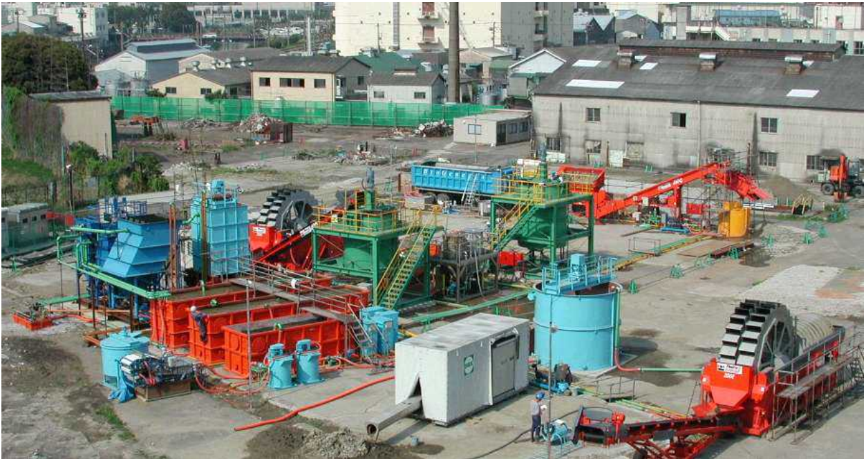
그림 1.5 BioGenesis사의 토양 퇴적물 세척 장치
