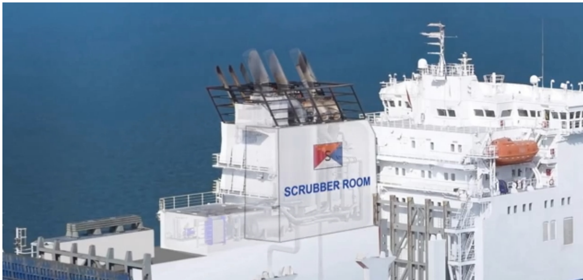
<그림 4.33> Alfa Laval사 SOx Scrubber의 설치를 위한 Scrubber Room (M/V Plyca)
