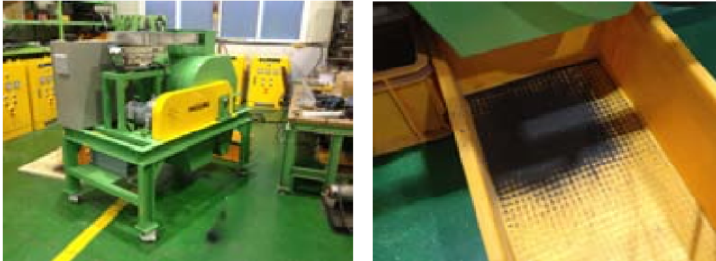
[그림 III-라-12] 자력분리기 이용 중금속 및 선박기원 유해물질을 함유한 자성입자(MSP) 분리과정 및 분리된 자성입자(MSP)
