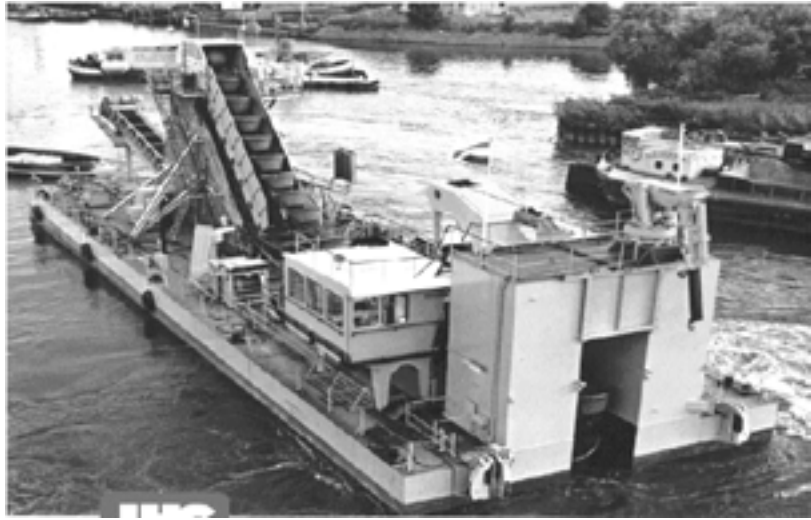
[그림. I-라-15] 버킷라다 준설기 (Bucket ladder dredger)
