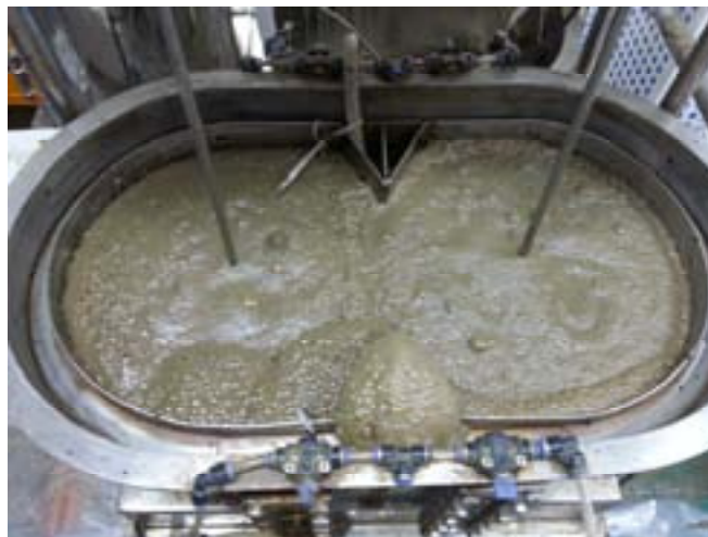
[그림 III-라-11. 미세기포 공정 추가 설계를 위한 벤치스케일 실험(bench-scale test)]
