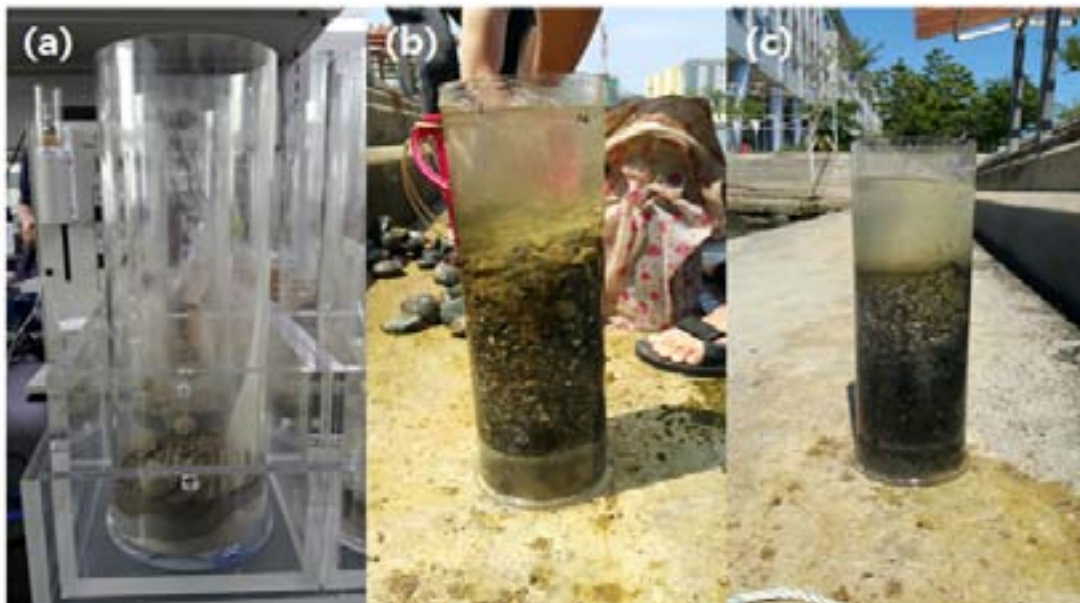
[그림. V-나-12] 실제 해양환경에서 미생물담체 ball의 중금속 안정화 모델 (a)해양환경 적용 전, (b)적용 15일 후, (c)적용 30일 후
