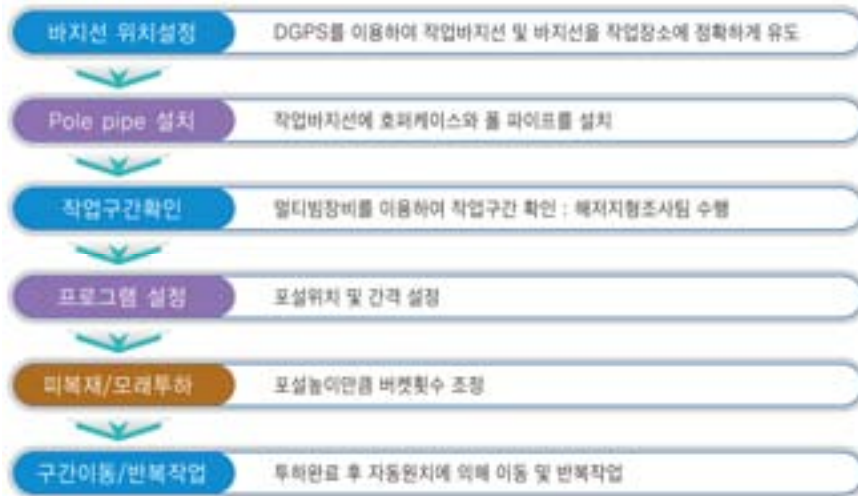
[그림. V-다-5] 셋팅바지를 이용한 자유낙하식 시공 순서도
