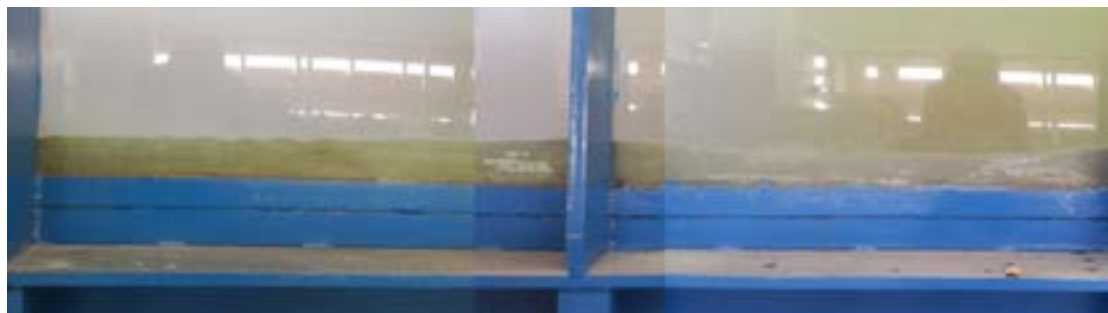
[그림 III-다-5] 침강 후 피복재 형상(중앙부 3.0~4.0 m 구간)
