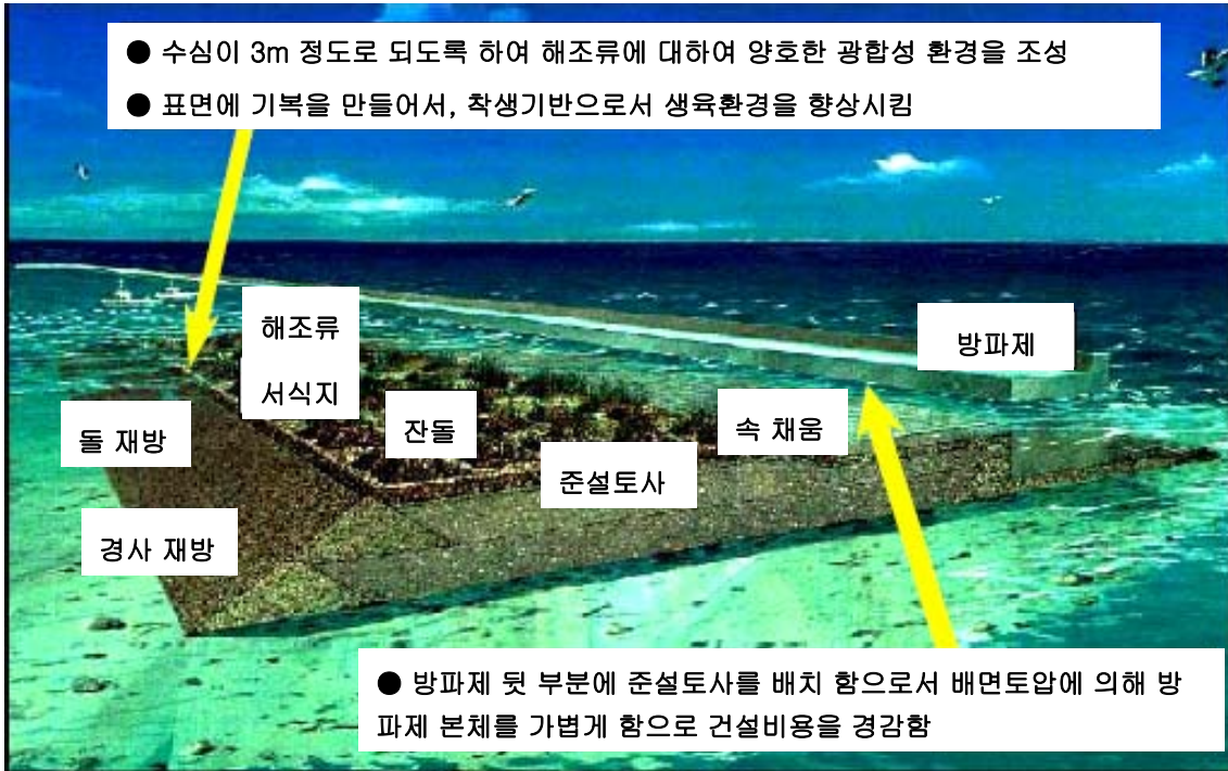
[그림. I-가-7] 일본의 해양오염퇴적물 재활용 사례(방파제 조성)
