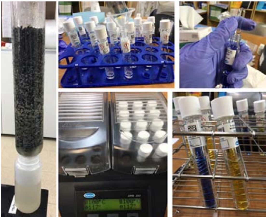
[그림. V-마-31] 실험실 내에서의 활성탄 여과 과정 및 공정수의 총유기탄소 측정
