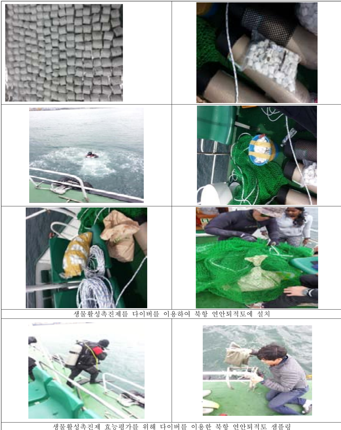
[그림. V-나-21] 생물활성촉진제 현장 효능평가를 위한 북항 연안퇴적도에 생물활성촉진제 설치 및 퇴적도 샘플링
