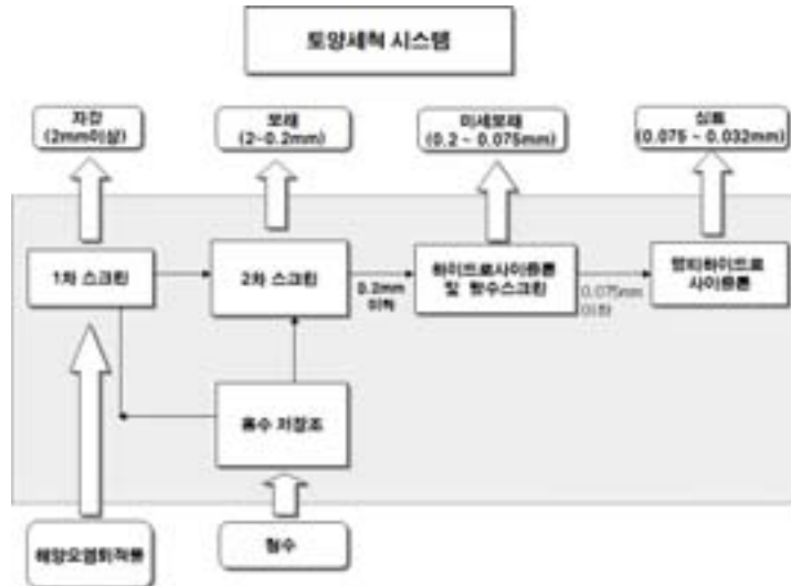
[그림 II-바-21] 입자분리기반 개념설계도(PFD)
