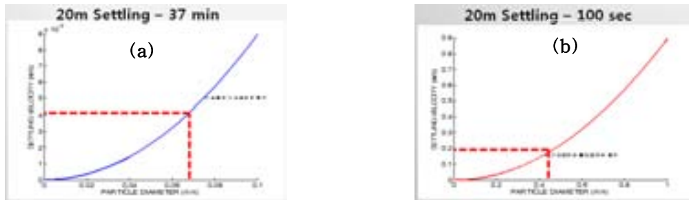
[그림. I-마-54] 입자 크기에 따른 수심 20m 침강 시간(Stoke's Law); a) 실트와 점토 (약 37분 소요), b) 모래 (약 100초 소요)
