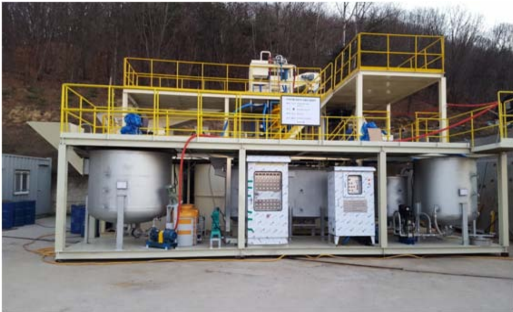
[그림. V-마-1] 현장 정화처리 실증장치(경기도 이천 소재, 오염토양 반입정화시설, H-Plus eco(주))
