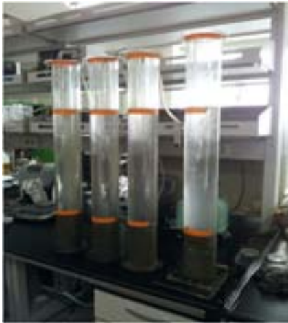
[그림. I-사-18] column 시험에서 air lift 사용 전(좌), air lift 사용 후(우)
