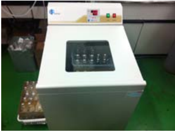
[그림. I-바-21] 미생물 배양 인큐베이터 (좌)와 혐기성 조건을 gas purging 시설(우)
