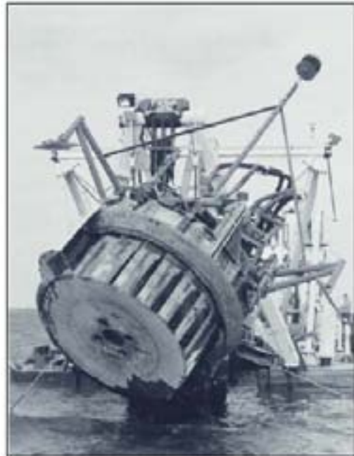
[그림. I -라-30] 원통형 모양의 디스크바닥준설선
