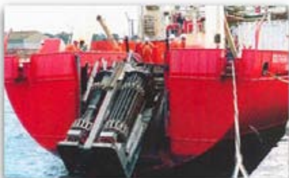
[그림. I-바-37] 착저형 해양콘관입시험장비 (최대 수심 50m 내외)
