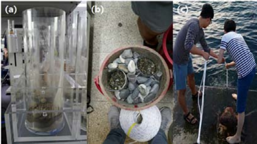
[그림. V-나-11] 미생물담체 ball을 이용한 실제해양환경의 다성분 중금속 오염퇴적물 안정화 실험 (a)안정화 실험샘플, (b)실험진행준비, (c)현장적용사진
