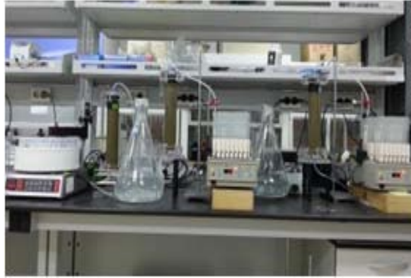
[그림 II-가-19. 컬럼 실험 모식도 및 인(Phosphorus)용출차단 컬럼실험장치]
