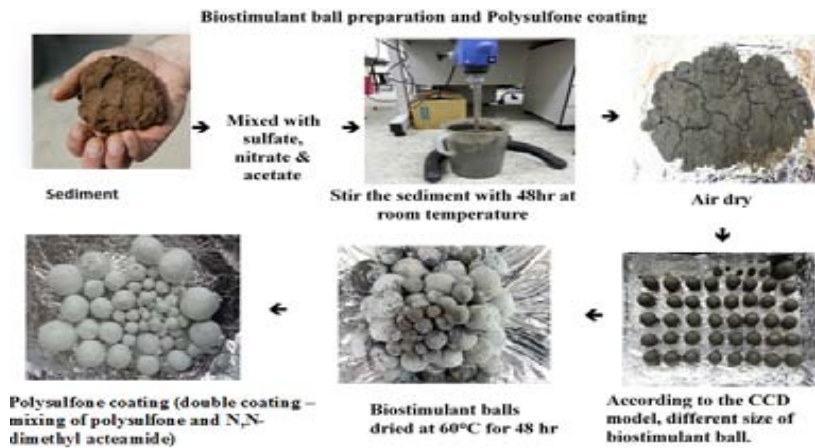
[그림 IV-나-18] 최적운영인자 연구에 사용된 생물활성촉진제의 제작
