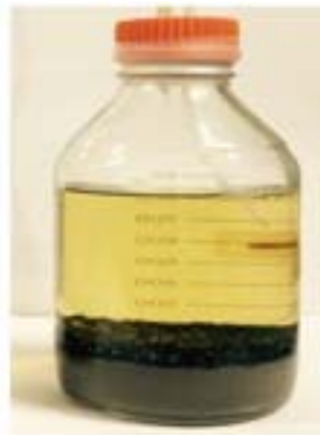
[그림 IV-나-8] 미생물 담체를 이용한 생물학적 피복 정화 실험
