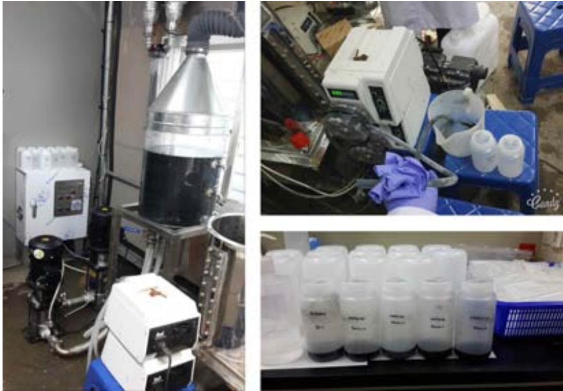
[그림. V-마-5] bench-scale의 고도산화처리 효율 실험
