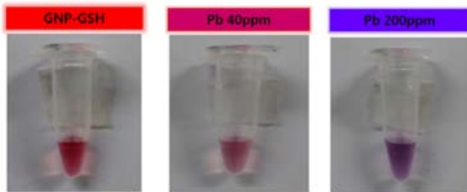
[그림. I-바-30] Pb이온에 의한 기능성 금나노입자 용액의 색변화
