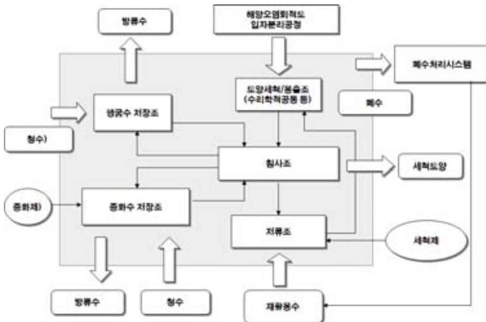
[그림 II-바-22] 세척기반 개념설계도(PFD)
