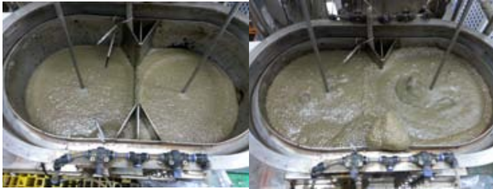
<초기> <중기> [그림 III-라-25. 미세기포 공정 추가 설계를 위한 벤치스케일 실험(bench-scale test)]
