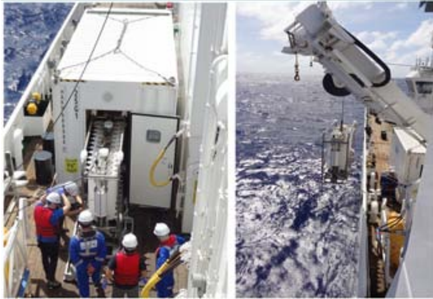
<그림 3-153> TEI ultraclean sampling system 해수 채취 운영
