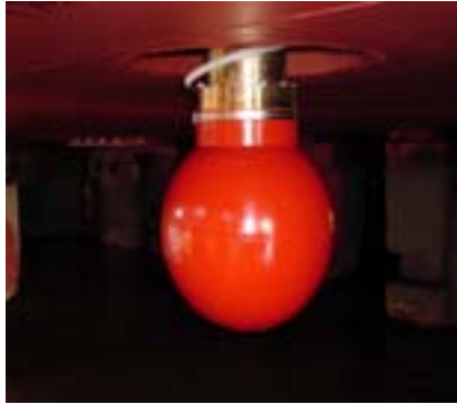
<그림 3-119> Hull based trunk mount type sensor 모양
