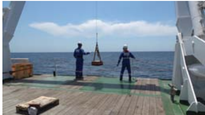
<그림 3-175> 진수(중량물 이용 작동상태 시험)
