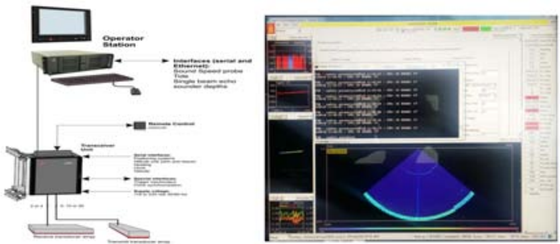
<그림 3-131> 천해용 다중음향측심기 구성도 및 화면
