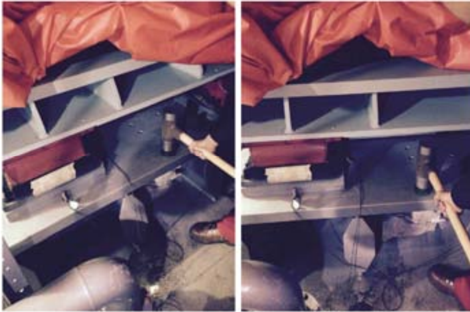
<그림 3-93> 주발전기 받침대 동강성 계측 모습
