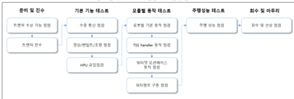
플랫폼 기본 동작 시험 및 전진 속도 검증 실험 순서도
