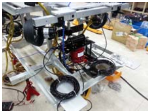
수중음향 전송 시스템 ROV 장착
