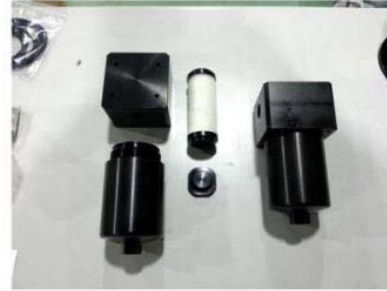
▷ 주 유압 압력라인 필터용(2개) - 5, 10micron PARKER 엘리먼트 ▷ 모터 절연유 순환라인 필터용(1개) - 10micron PARKER 엘리먼트
