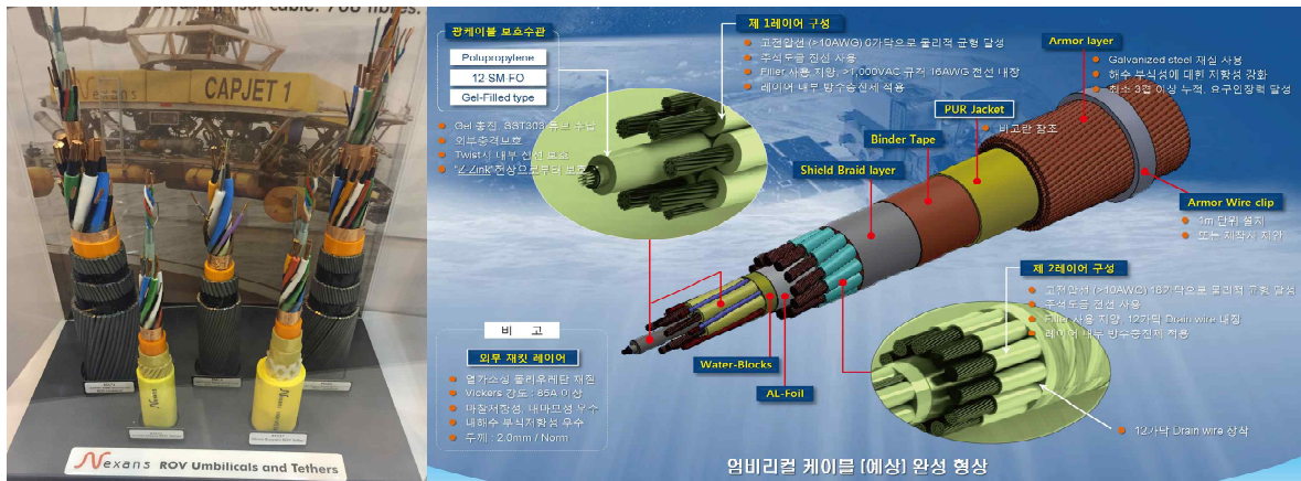
[그림 6-31] ROV 엄빌리컬 케이블의 실제 적용 사례와 수중건설로봇사업단 예상 모델 비교
