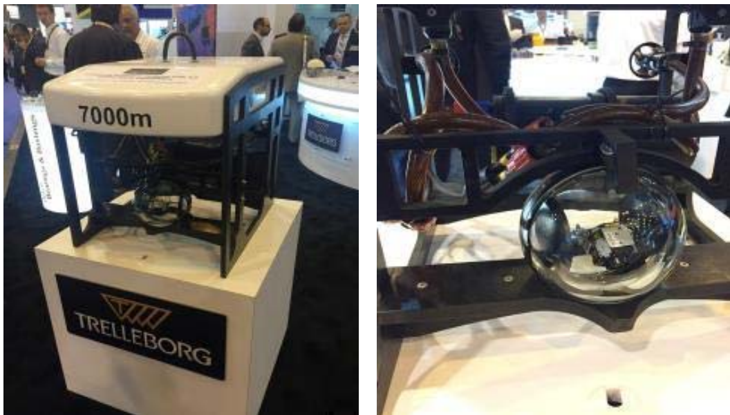
[그림 6-28] TRELLEBORG의 수중 모니터링을 위한 소형 ROV
