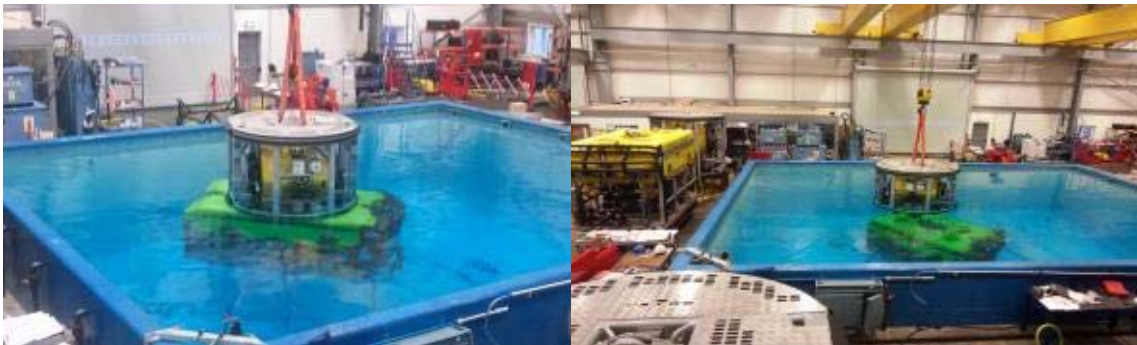
[그림 6-34] ROV, TMS 실내 수조 점검
