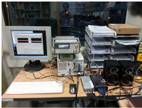
수중음향 전송 시스템 Lab 시험 장치
