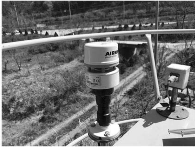
그림 168. 동해 광학 부이에 설치된 AirMar 센서의 모습
