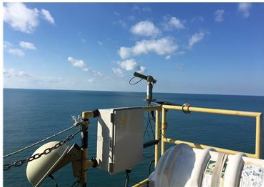
그림 175. 이어도 종합해양과학기지에 설치되어 운영 중인 CIMEL사의 Sun Photometer CE-318 Seaprism
