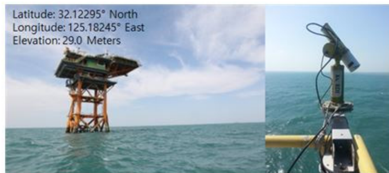
그림 180. AERONET-OC 가 설치된 이어도 해양과학기지의 모습(좌)과 기지에 설치된 CIMEL CE-318 Seaprisim Sun photometer 장비의 모습(우)
