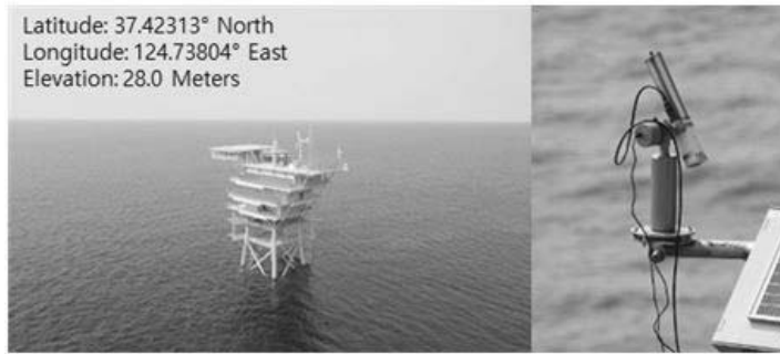
그림 182. AERONET-OC 가 설치된 소청초 해양과학기지의 모습(좌)과 기지에 설치된 CIMEL CE-318 Seaprisim Sun photometer 장비의 모습(우)
