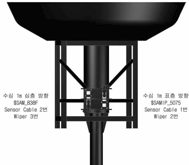
그림 170. 동해 광학 부이 수심 1m 지점에 설치된 TriOS 센서
