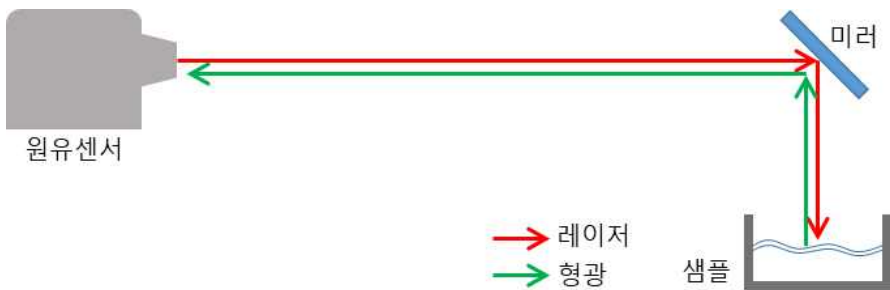
그림 2.3.3 원유 광학 센서 테스트 개략도
