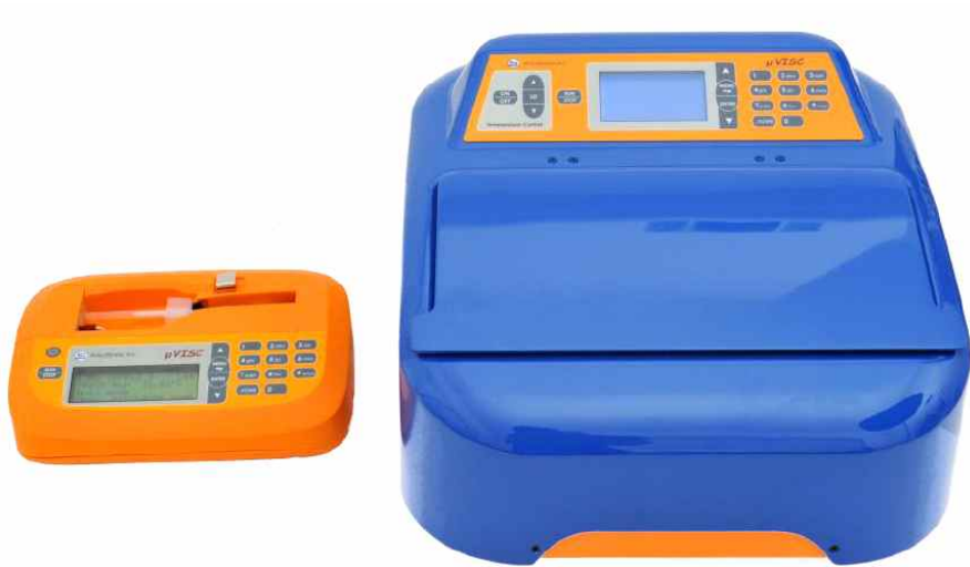
그림 2.1.2 점도 측정에 사용된 microVISC TM 와 온도 컨트롤러 (HVROC-T)
