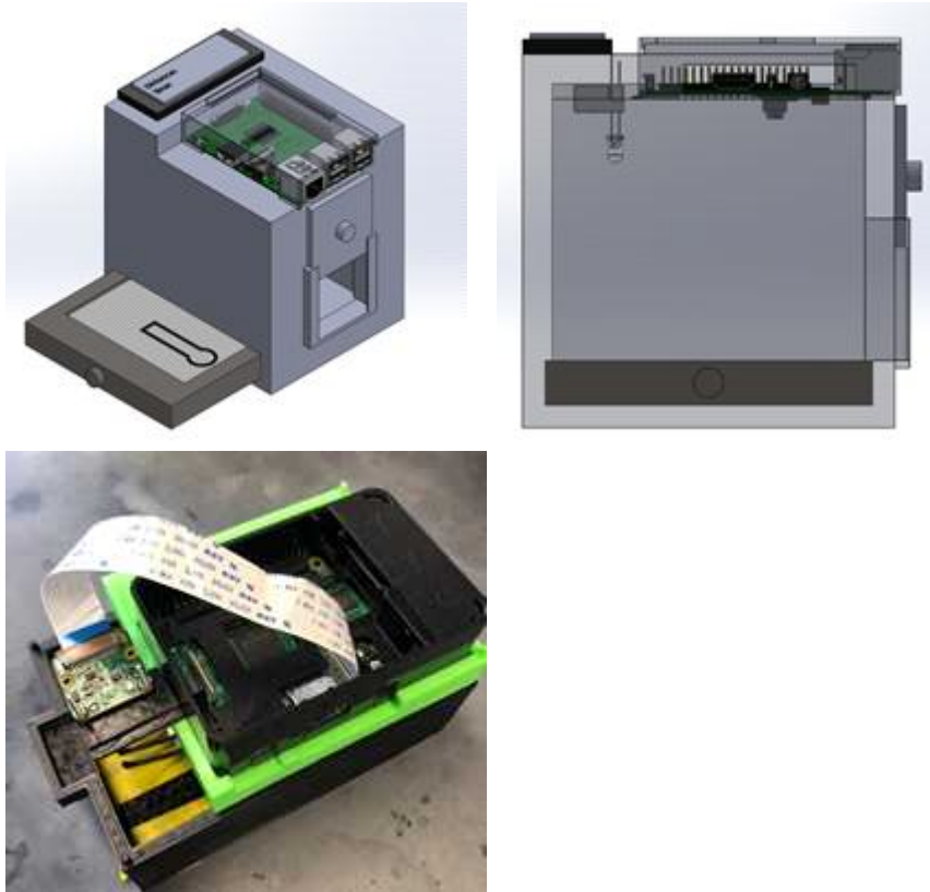
그림 2.4.7 프로토타입-B: 래즈베리 파이 기반 종이 마이크로플루이딕 분석 장치 사진 및 설계도
