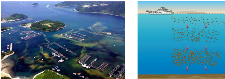
그림 6. 적조발생 해역에서 황토살포 모습(좌)과 원리(우)
