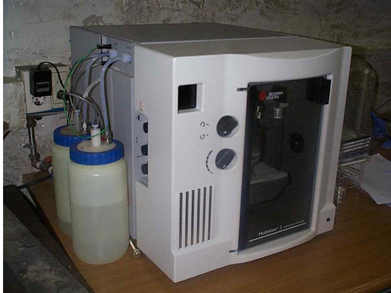
그림 3.3.12 대기 입자의 size distribution( F(d) )를 분석하기 위해 사용된 Beckman Coulter사의 Multisizer™ 3 Coulter Counter.
