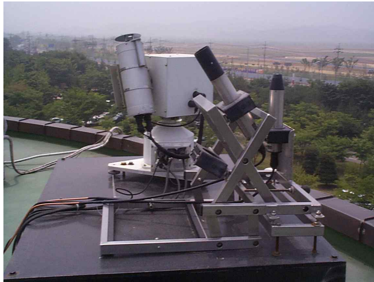
그림 3.3.4 태양과 대기의 광학적 특성을 측정하기 위해 한국해양연구원 제3연구동 옥상에 함께 설치된 Sunphotometer와 Hyperspectral radiometer.
