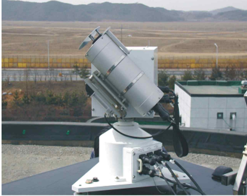
그림 3.3.5 한국해양연구원에 설치된 PREDE사의 Grating sunphotometer PGS-100.
