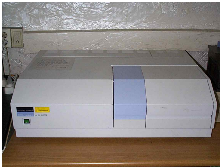
그림 3.3.13 대기 입자의 흡수 계수(absorption coefficient, a(\lambda) )와 소산 계수(attenuation coefficient, c(\lambda) )를 측정하기 위해 사용된 Perkin Elmer사의 Lambda 19 UV/VIS/NIR Spectrophotometer.
